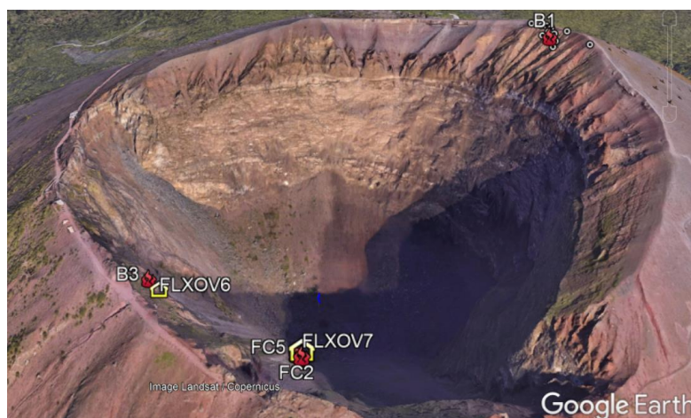
Figura 4.1.1 - Ubicazione della stazione multiparametrica FLOX6 (bordo cratere), della stazione FLXOV7 (fondo cratere) e dei siti dove sono eseguite le attività di sorveglianza geochimica in area craterica. In particolare sono riportate le principali fumarole di bordo cratere (B1-B3) e di fondo cratere (FC2 e FC5), sono inoltre riportati i punti fissi per la misura del flusso di CO 2 dal suolo e della temperatura del suolo, in area bordo cratere (simboli bianchi) e in area di fondo cratere (simboli gialli).
