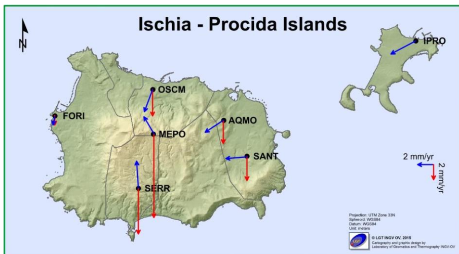
Figura 2.1.4 - Campo di velocità (in mm/anno) degli spostamenti orizzontali (in blu) e verticali (in rosso) alle isole di Ischia e Procida.
