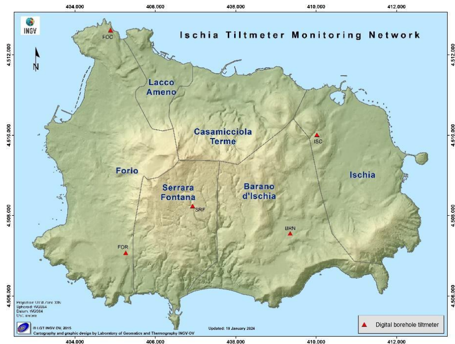
Figura 2.2.1 – Mappa della Rete Tiltmetrica di Ischia.
