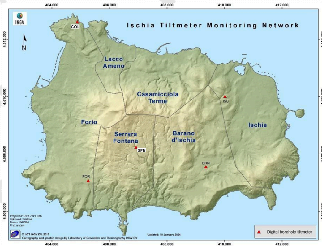
Figura 2.2.1 - Rete Tiltmetrica dell'Isola d'Ischia (DOI: 10.5281/zenodo.5886962).
