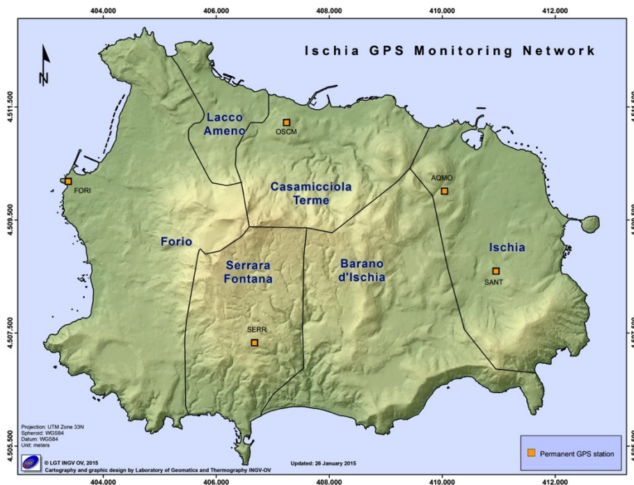
Figura 3.2.1 - Rete GPS permanente di Ischia
