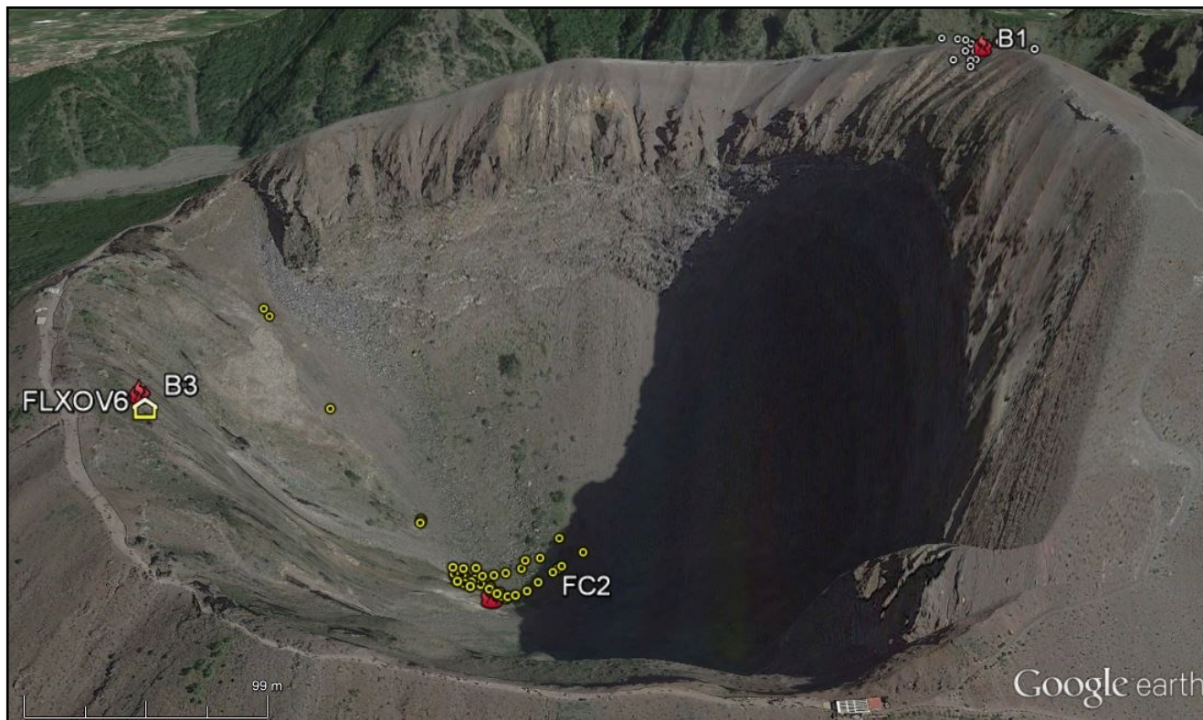
Figura 1.4.1 - Ubicazione della stazione multiparametrica FLXOV6 e dei siti oggetto delle attività di sorveglianza geochimica in area craterica. In particolare, sono riportate le principali fumarole di bordo cratere (B1-B3) e di fondo cratere (FC2), sono inoltre riportati i punti fissi per la misura del flusso di CO 2 dal suolo e della temperatura del suolo, in area bordo cratere (simboli bianchi) e in area di fondo cratere (simboli gialli).
