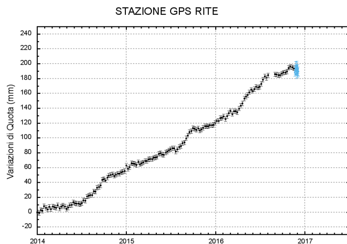
Figura 2.2.3 - Serie temporale delle variazioni in quota della stazione di RITE (Pozzuoli) dal 01 gennaio 2014 al 05 dicembre 2016.
