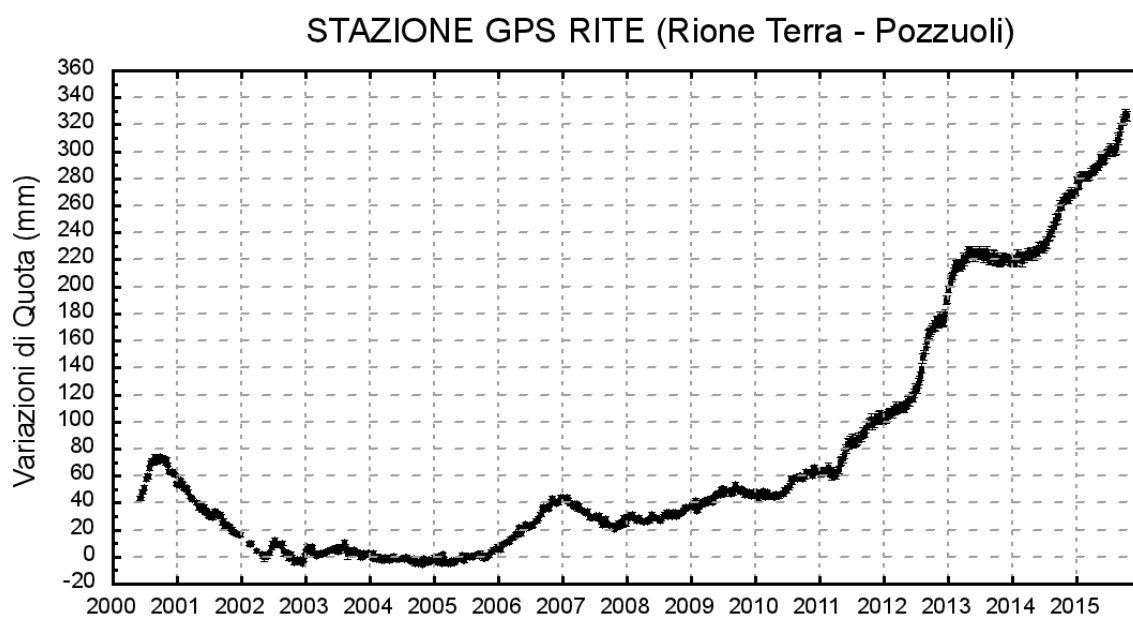
Figura 2.2.1 - Serie temporale delle variazioni settimanali in quota della stazione di RITE (Pozzuoli) dal 2000 ad ottobre 2015.
