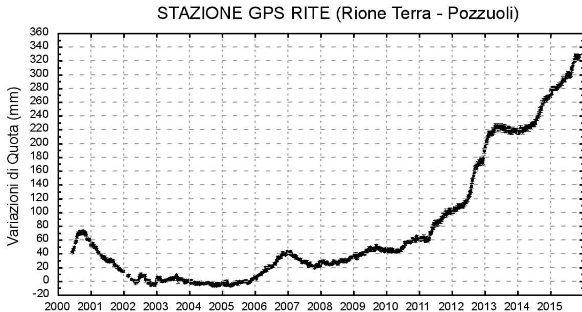
Figura 2.2.1 - Serie temporale delle variazioni settimanali in quota della stazione di RITE (Pozzuoli) dal 2000 a novembre 2015.
