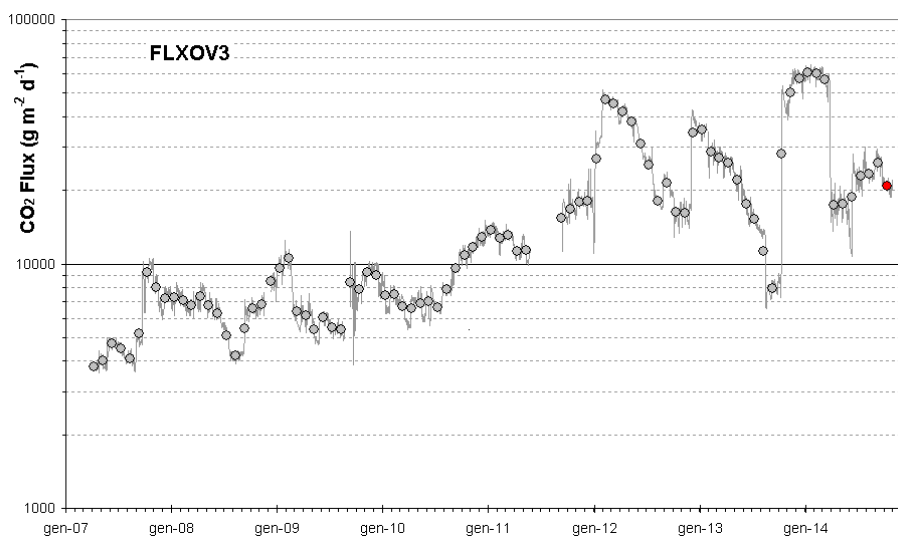
Figura 2.3.8 - Medie giornaliere (linea) e medie mensili (cerchi) dei flussi di CO 2 misurati a Pisciarelli (FLXOV3). La media mensile dei flussi relativa al mese di Ottobre 2014 è riportata con il simbolo rosso. I flussi di CO 2 dal suolo mostrano una lieve diminuzione rispetto ai mesi precedenti.
