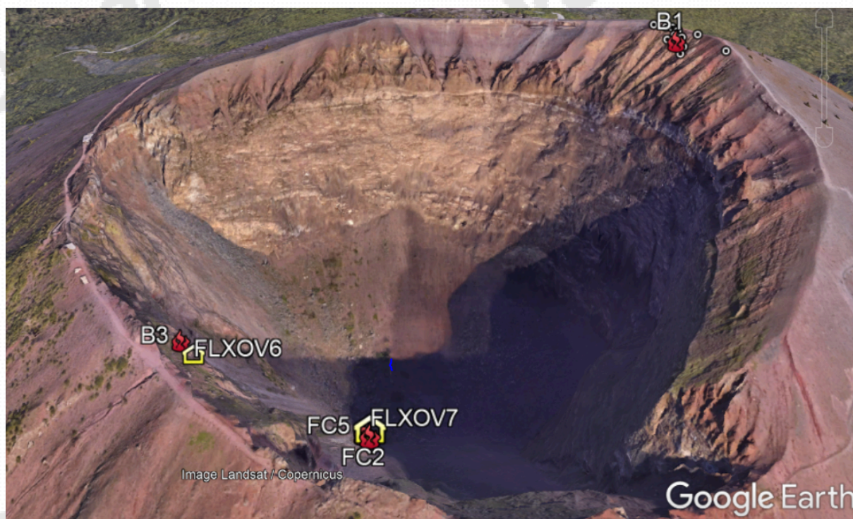
Figura 4.1 - Ubicazione delle stazioni multiparametriche FLXOV6 e FLXOV7, e dei siti oggetto delle attività di sorveglianza geochimica in area craterica. In particolare, sono riportate le principali fumarole di bordo cratere (B1-B3) e di fondo cratere (FC2, FC5), sono inoltre riportati i punti fissi per la misura del flusso di CO 2 dal suolo e della temperatura del suolo, in area bordo cratere (simboli bianchi).
