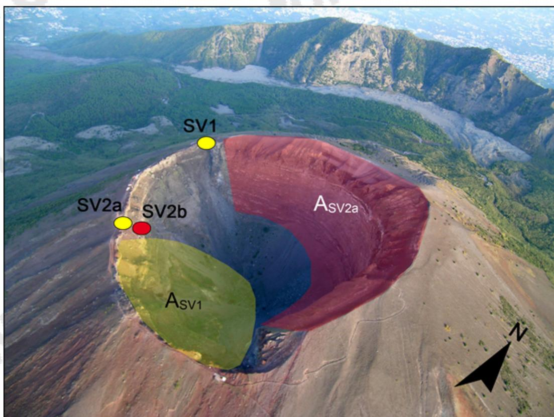
**Figura 3.2.1** – Cratere del Vesuvio. In giallo sono riportati i punti stazione dai quali vengono effettuati i rilievi termici con telecamera termica, in rosso quello nel quale viene utilizzata anche termocoppia rigida. L'area in rosso (ASV2a) è quella ripresa dal punto stazione SV2a, mentre l'area in giallo (ASV1) è ripresa dal punto stazione SV1.
