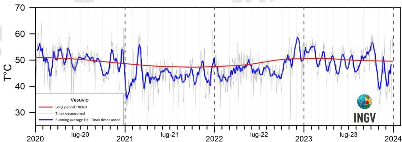
**Figura 3.1.2** - Stazione Vesuvio VES1. Serie temporali dei valori di temperatura massima giornaliera rilevata nelle immagini IR, destagionalizzate mediante applicazione dell'algoritmo BR (medie settimanali termocamera 640x480).
