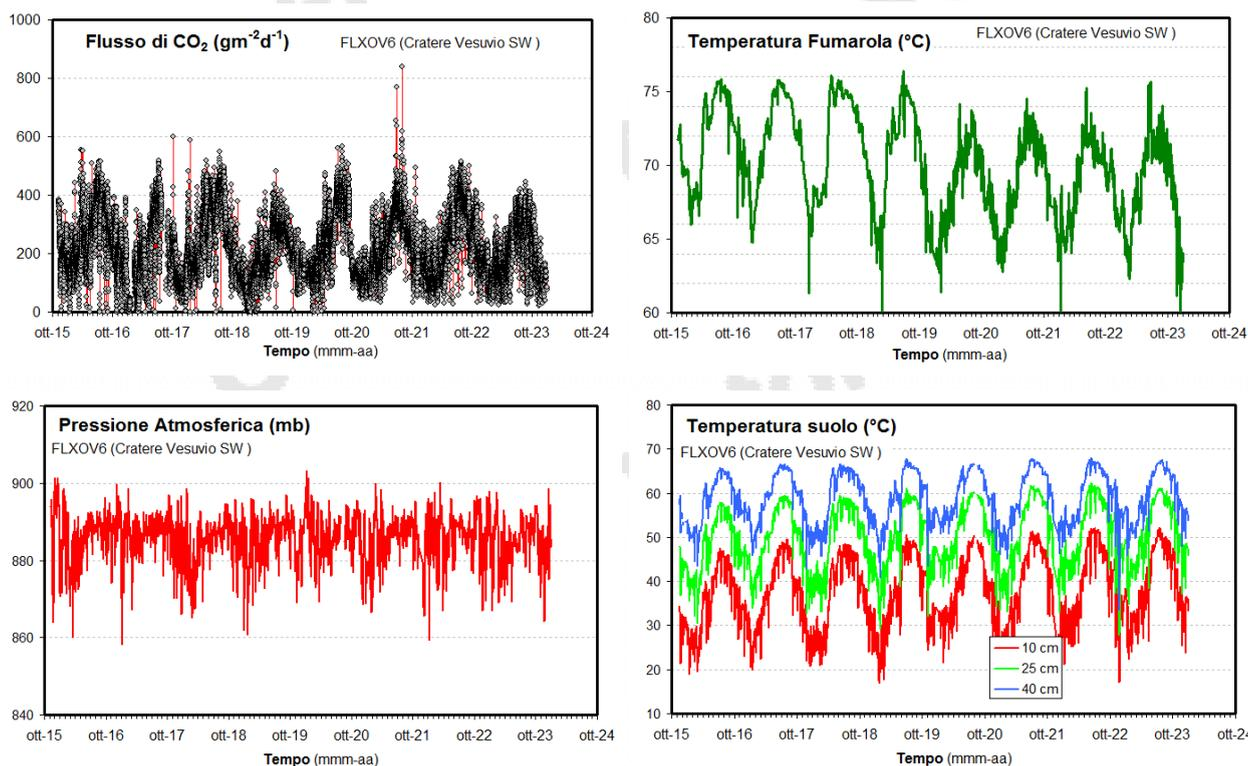
**Figura 4.3** - Parametri misurati dalla stazione geochimica (FLXOV6) installata in area bordo cratere del Vesuvio (setto SW). I valori, eccetto il flusso di CO<sub>2</sub> dal suolo, sono riportati come medie giornaliere.
