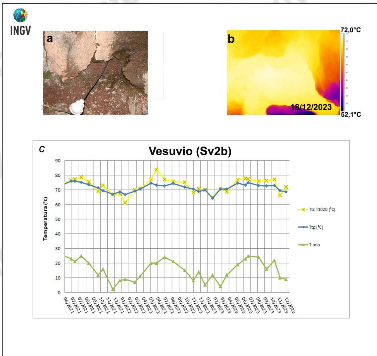
**Figura 3.2.2** - Immagini nel visibile (a) e termica (b) riprese al punto SV2b di Figura 3.2.1, di una fumarola ubicata sul settore occidentale del cratere del Vesuvio. Valori massimi di temperatura rilevati con la termocamera FLIR T1020 (TtcT1020) e con la termocoppia (Ttp), confrontati con la temperatura dell'aria (Taria) misurata nel momento del rilievo termico, da giugno 2021 a dicembre 2023 (c).
