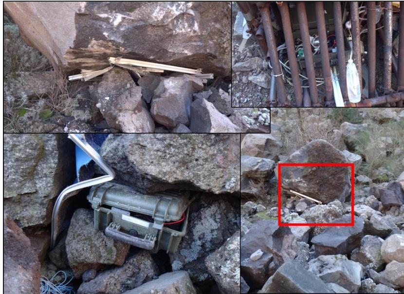
**Figura 4.4** - Eventi franosi hanno danneggiato il sistema di alimentazione combinato eolico-solare della stazione di fondo cratere FLXOV7.
