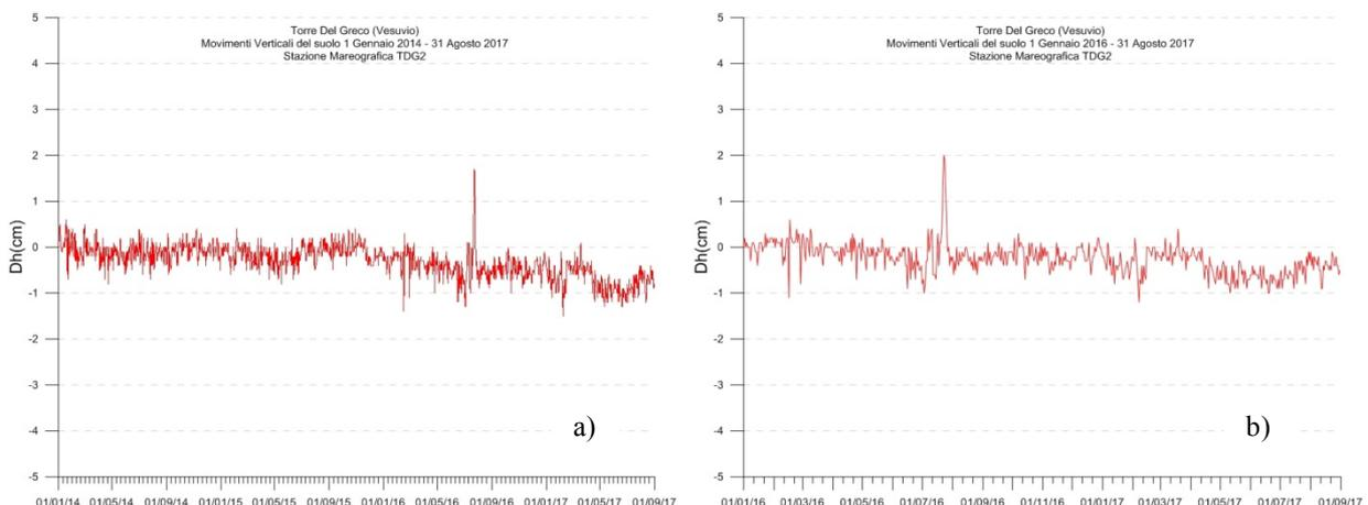
**Figura 2.4** - Movimenti verticali del suolo, nel periodo gennaio 2014-agosto 2017 (a) e gennaio 2016-agosto 2017 (b), ottenuti dall'analisi dei dati acquisiti dal sensore digitale alla stazione mareografica di Torre del
