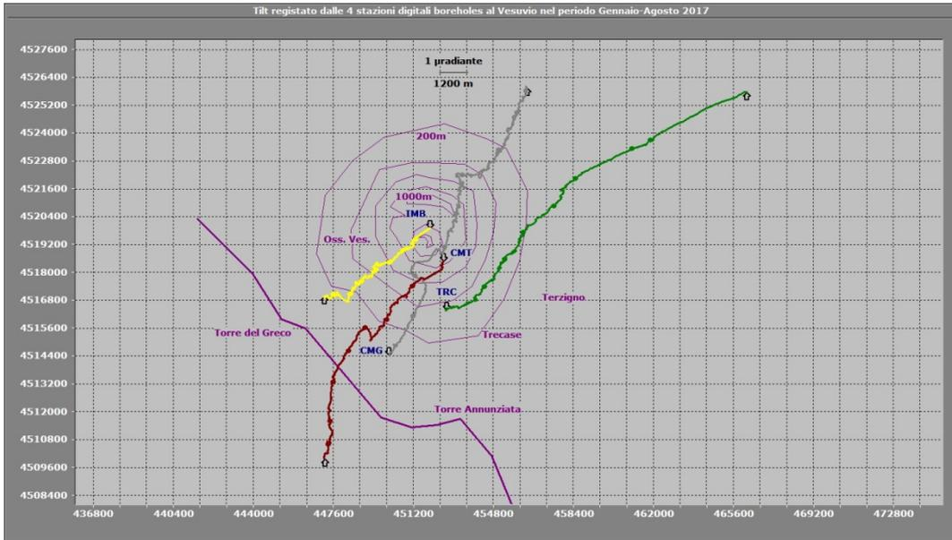
**Figura 2.6** – Odografo del tilting registrato alle stazioni del Vesuvio nel periodo gennaio-agosto 2017. Per chiarezza di rappresentazione grafica sono state selezionate solo le stazioni borehole con sensori ubicati tra 20 e 25 m di profondità.
