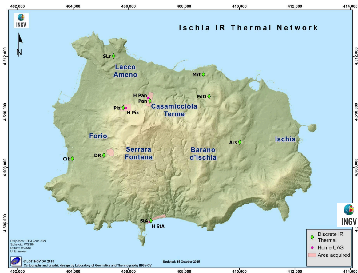
Figura 3.1 – Ubicazione dei punti di misura con Telecamere Termiche Mobili a Ischia. I rombi verdi indicano i punti stazione in cui sono stati effettuati rilievi termici con termocoppia rigida e telecamera termica. In rosa sono evidenziate le aree riprese da termocamera a mano o da drone, mentre gli esagoni fucsia indicano la Home da cui il drone decolla e atterra.
