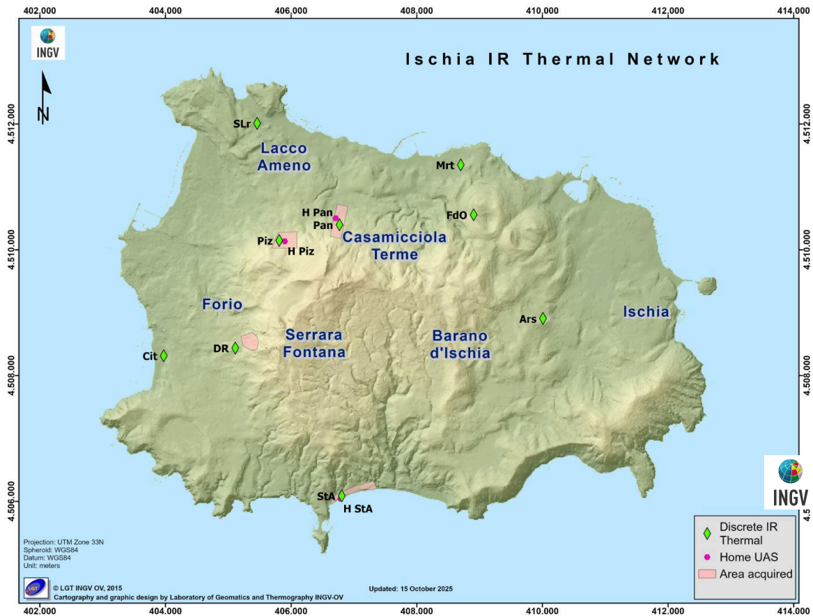
Figura 3.1 – Ubicazione dei punti di misura con Telecamere Termiche Mobili a Ischia. I rombi verdi indicano i punti stazione in cui sono stati effettuati rilievi termici con termocoppia rigida e telecamera termica. In rosa sono evidenziate le aree riprese da termocamera a mano o da drone, mentre gli esagoni fucsia indicano la Home da cui il drone decolla e atterra.
