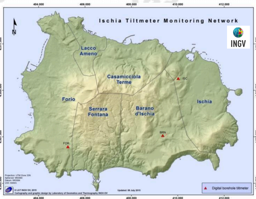
Figura 2.2.1 - Rete Tiltmetrica dell'Isola d'Ischia (DOI: 10.5281/zenodo.5886962).
