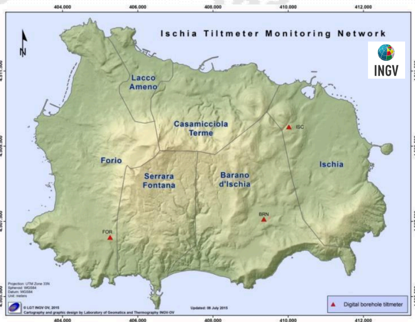
Figura 2.2.1 - Rete Tiltmetrica dell'Isola d'Ischia (DOI: 10.5281/zenodo.5886962).
