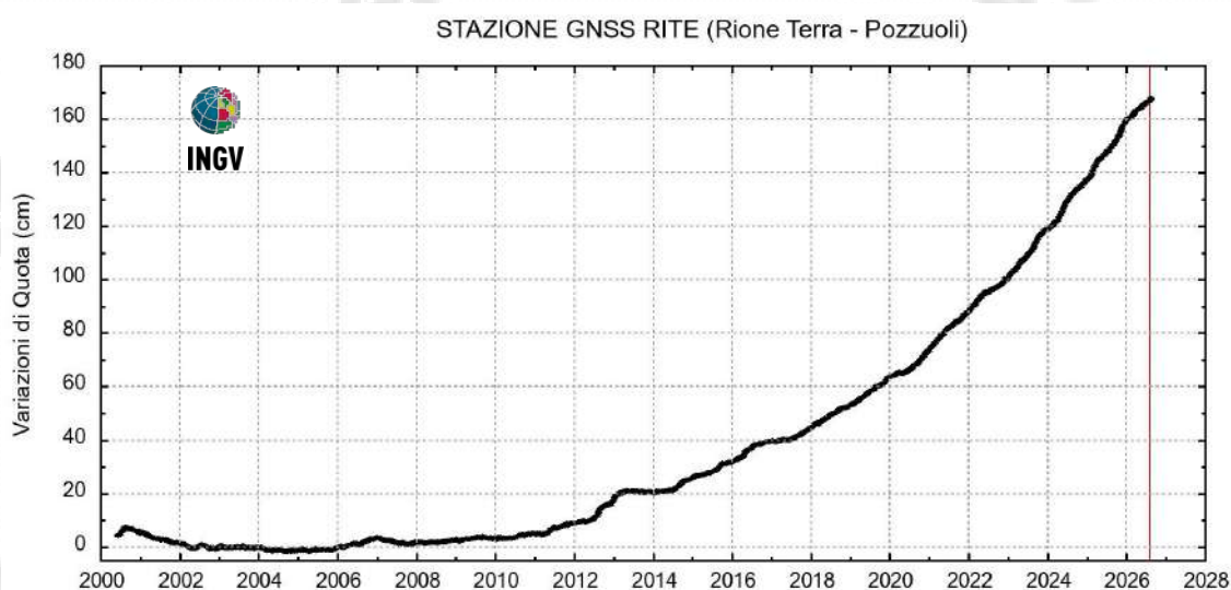
Figura 2.1.5 - Serie temporale delle variazioni settimanali in quota della stazione GNSS di RITE (Pozzuoli - Rione Terra) dal 2000 ad agosto 2026, senza la discontinuità cosismica del 31/07. La linea verticale rossa indica la data del 31/07.
