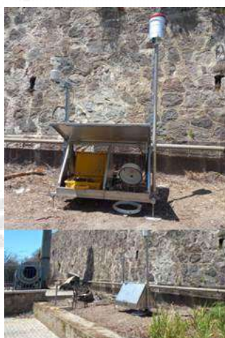
Figura 4.16 - Stazione geochimica installata il 19 maggio 2026 presso l'Istituto Professionale "Lucio Petronio" per la misura del flusso di CO 2 dal suolo, delle temperature del suolo e dei parametri atmosferici.
