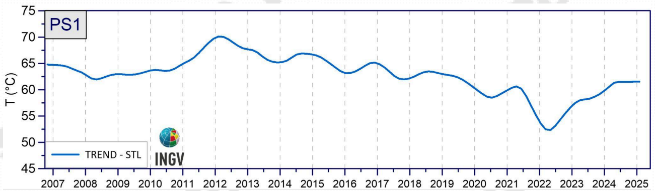
Figura 3.1.4 - Stazione PS1: Trend a lungo termine dei valori di temperatura massima rilevati nelle immagini IR ottenuto mediante applicazione dell'algoritmo STL.
