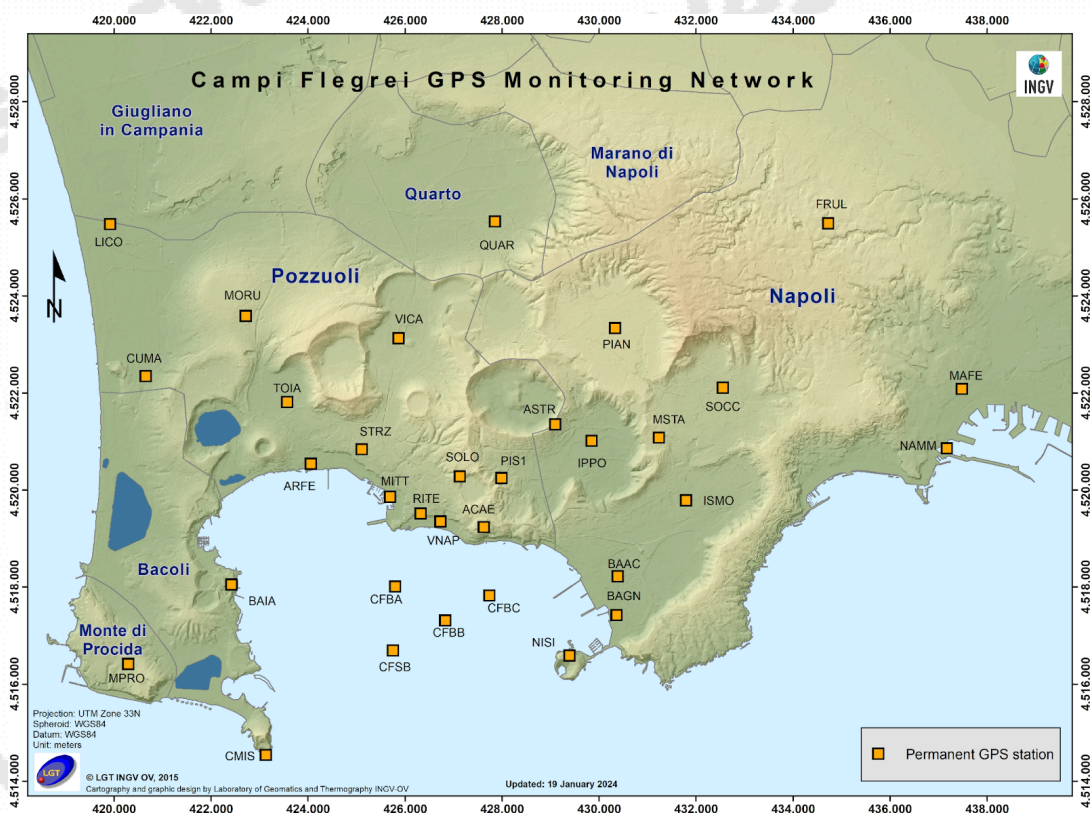
Figura 2.1.1 - Rete GNSS Permanente dei Campi Flegrei (DOI: 10.5281/zenodo.5886962).
