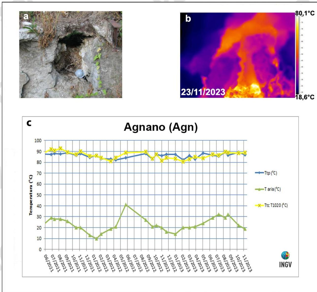
**Figura 3.2.4** – Fumarola all'interno dello stabilimento termale delle “Terme di Agnano”. Immagini nel visibile (a) e termica (b) riprese dal punto stazione Agn di Figura 3.2.1c. Valori massimi di temperatura rilevati con la termocamera FLIR T1020 (TtcT1020) e con la termocoppia (Ttp), confrontati con la temperatura dell'aria (Taria) misurata nel momento del rilievo termico, da giugno 2021 a novembre 2023 (c).
