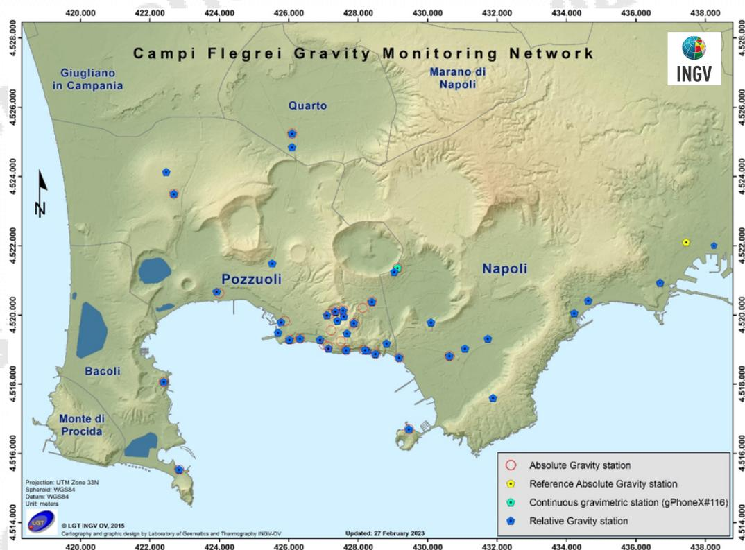
**Figura 2.4.1** - Vertici della rete gravimetrica dell'OV-INGV ([www.ov.ingv.it](http://www.ov.ingv.it)). Il punto giallo, che rappresenta il caposaldo assoluto di riferimento, è localizzato presso il complesso monumentale di Largo San Marcellino (Napoli).
