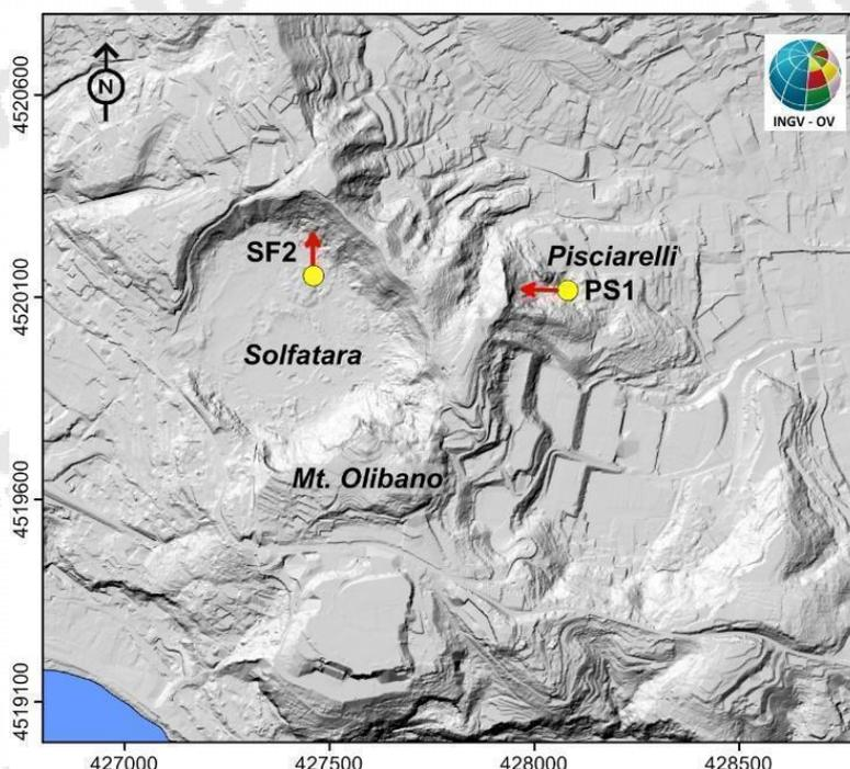
**Figura 3.1.1** - Mappa della Rete Permanente di Monitoraggio Termico ad immagine (TIRNet) con l'ubicazione delle stazioni SF2 e PS1. Pallini Gialli: indicano i punti di ripresa; frecce rosse: indicano schematicamente le aree campionate.
