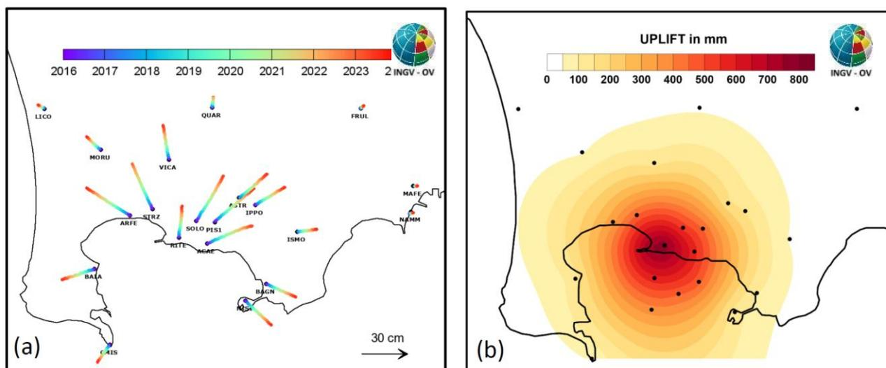
**Figura 2.1.5** - Mappa degli spostamenti GNSS orizzontali (a) e verticali (b) registrati nell'area flegrea da gennaio 2016 a luglio 2023.
