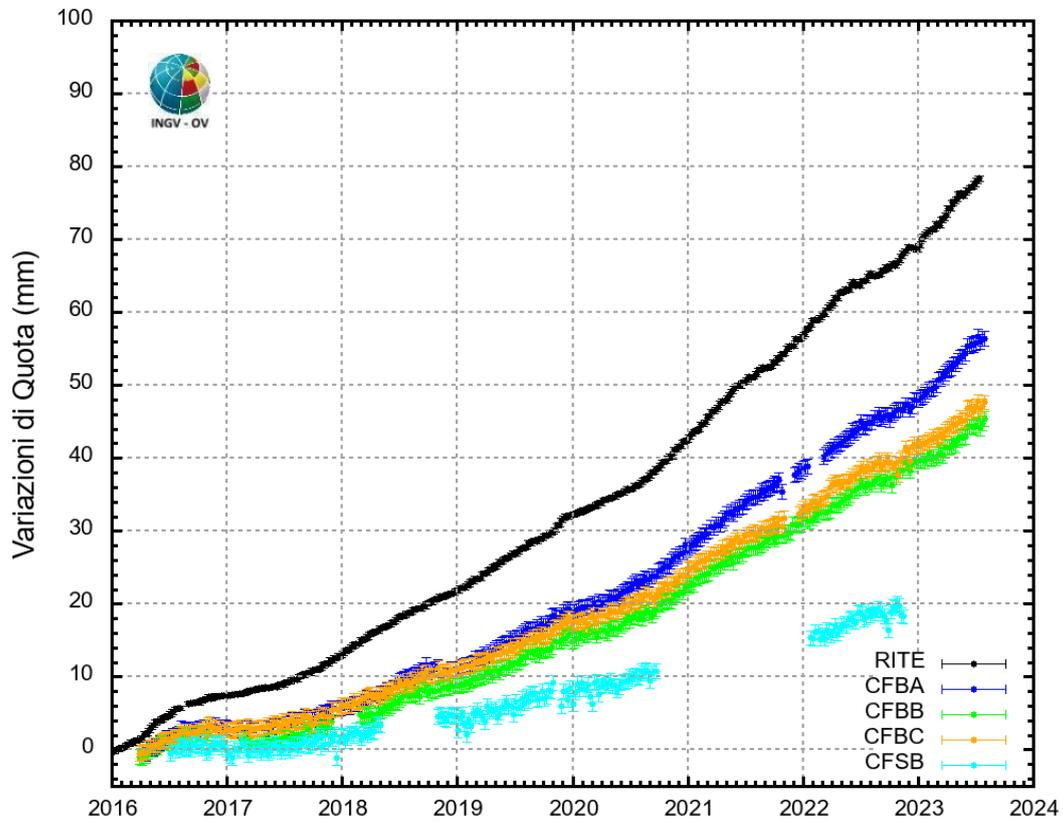
**Figura 2.1.6** – Serie temporali delle variazioni in quota delle stazioni GNSS dell'infrastruttura marina sistema MEDUSA nell'intervallo aprile 2016 – luglio 2023, confrontate con quella della stazione RITE.
