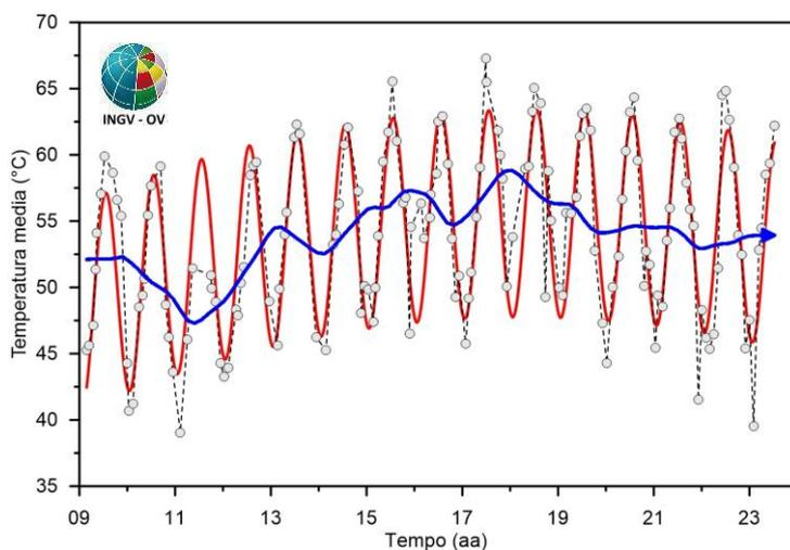
**Figura 4.9** – Cronogramma della media delle temperature del suolo (a 10 cm di profondità) misurate su 25 punti fissi nell'area di Pisciarelli dal 2009. Il trend destagionalizzato, mediante l'utilizzo dell'algoritmo di destagionalizzazione STL (Seasonal-Trend decomposition based on Loess, Cleveland et al., 1990), è riportato con la linea blu.
