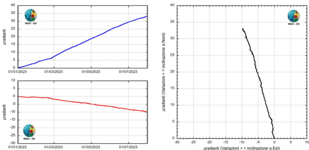
**Figura 2.2.2** – Serie temporali e plot del tilt della stazione CMP della rete dei Campi Flegrei da gennaio a luglio 2023
