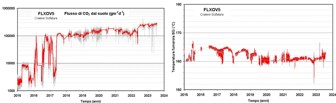
**Figura 4.11** – Valori del flusso di CO<sub>2</sub> dal suolo e della temperatura della fumarola BG misurati dalla stazione FLXOV5 installata nel cratere della Solfatara, a pochi metri dalla fumarola principale BG. I valori di flusso di CO<sub>2</sub> dal suolo mostrano, in generale, un significativo incremento a partire dal 2016 (la linea rossa si riferisce alle medie giornaliere).
