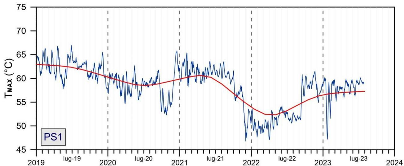
**Figura 3.1.3** - Stazione PS1. Serie temporali dei valori di temperatura massima giornaliera rilevata nelle immagini IR destagionalizzate mediante applicazione dell'algoritmo STL [medie settimanali (blu); trend a lungo termine (rosso)].
