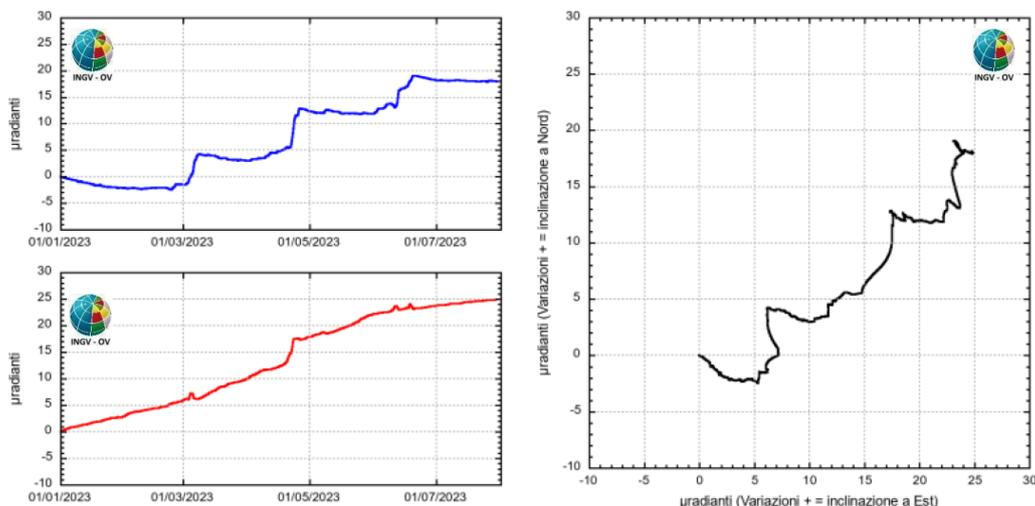
Figura 2.2.4 – Serie temporali e plot del tilt della stazione HDM della rete dei Campi Flegrei da gennaio a luglio 2023
