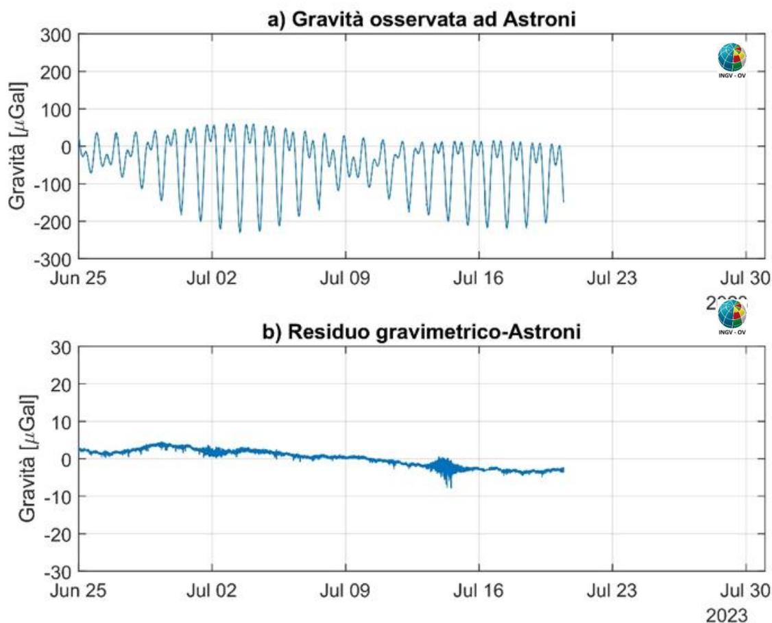
**Figura 2.4.1** a: serie temporale (risoluzione temporale 1 minuto) raw registrata dal gPhone. Si osserva il contributo dominante delle maree. b: serie residua di gravità; le variazioni di gravità hanno ampiezza limitata, inferiori ai 10  $\mu\text{Gal}$ .
