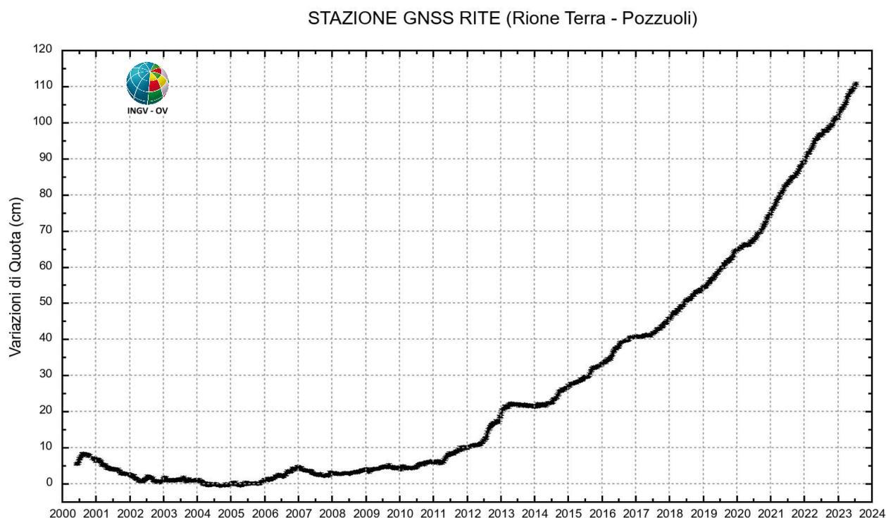
**Figura 2.1.3** - Serie temporale delle variazioni settimanali in quota della stazione di RITE (Pozzuoli – Rione Terra) dal 2000 a luglio 2023.
