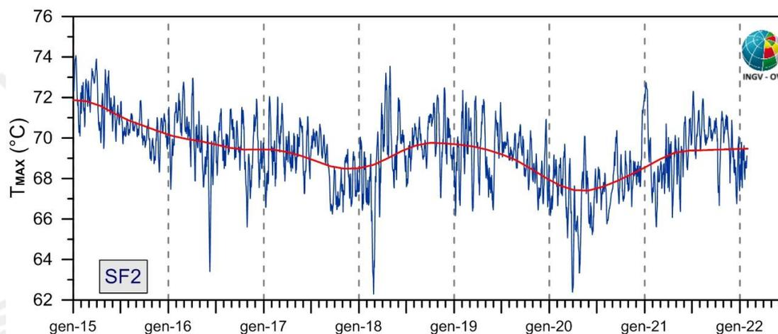
**Figura 3.1.2** - Stazione SF2: Serie temporali dei valori di temperatura massima giornaliera rilevata nelle immagini IR destagionalizzate mediante applicazione dell'algoritmo STL [medie settimanali (blu); trend a lungo termine (rosso)].
