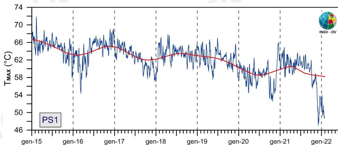
**Figura 3.1.3** - Stazione PS1. Serie temporali dei valori di temperatura massima giornaliera rilevata nelle immagini IR destagionalizzate mediante applicazione dell'algoritmo STL [medie settimanali (blu); trend a lungo termine (rosso)].
