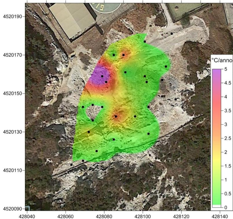
**Figura 4.10** - Mappa dell'incremento di temperatura in °C/anno calcolato per ognuno dei 25 punti misurati a partire dal 2009. L'incremento di temperatura interessa tutta l'area indagata con le zone di maggiore riscaldamento legate a processi di fumarizzazione locale.
