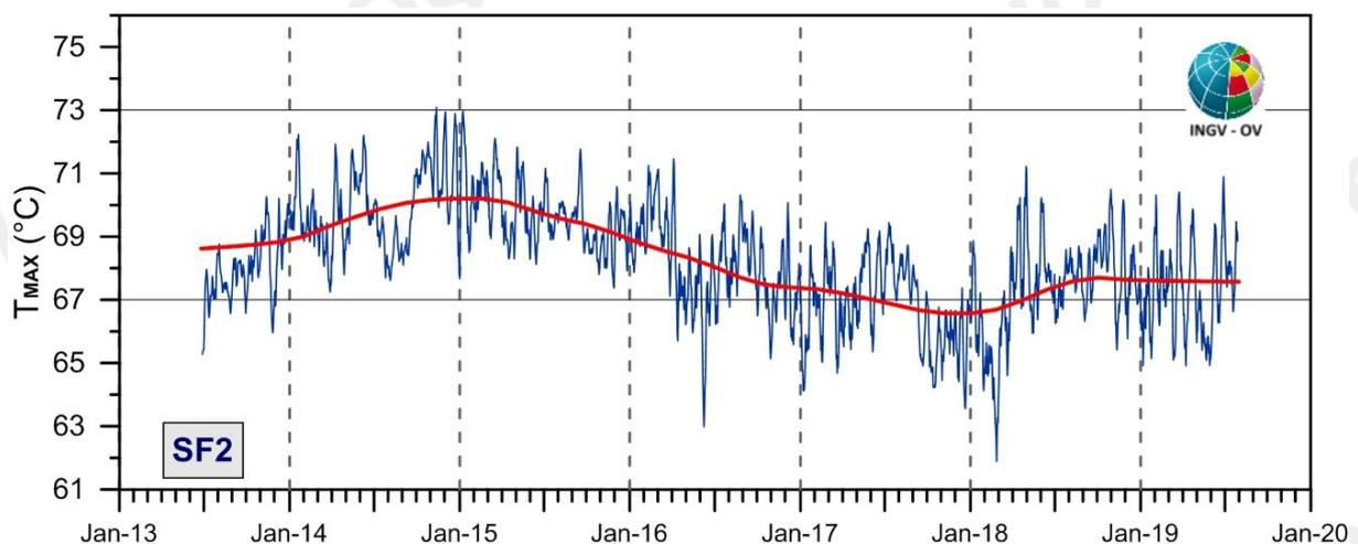
**Figura 3.1.2** - Stazione SF2. Serie temporali delle medie settimanali (blu) e del trend a lungo termine (rosso) dei valori di temperatura massima rilevati nell'immagine IR destagionalizzata mediante applicazione dell'algoritmo STL.
