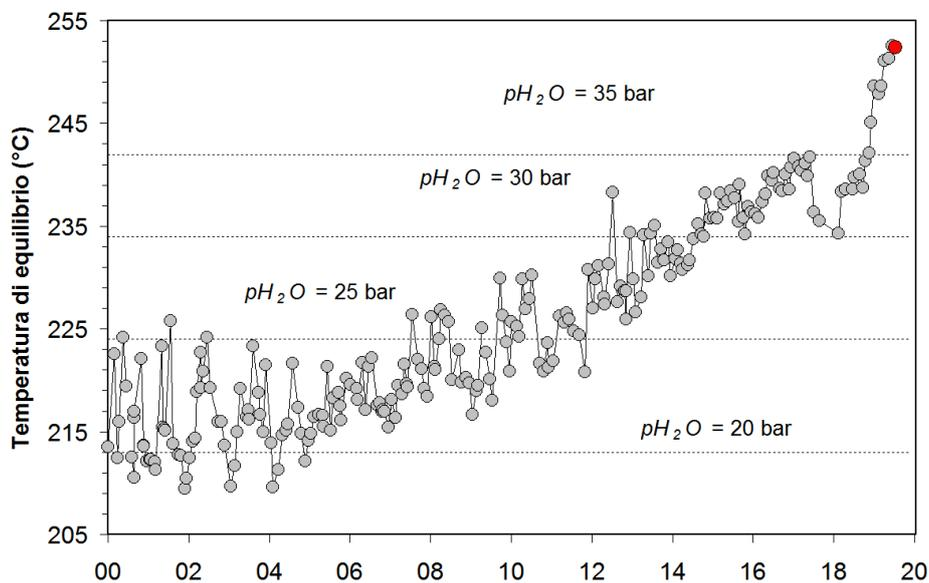
**Figura 4.4** – Cronogramma delle temperature di equilibrio per il sistema CO-CO<sub>2</sub>, stimate assumendo condizioni redox fissate dalla relazione di D'Amore and Panichi (1980). Tali temperature, rappresentative della parte più superficiale del sistema idrotermale (Caliro et al., 2007), mostrano un trend d'aumento a partire dai primi anni del 2000. Con il simbolo rosso è evidenziato il campione di luglio 2019 relativo alla fumarola BG.
