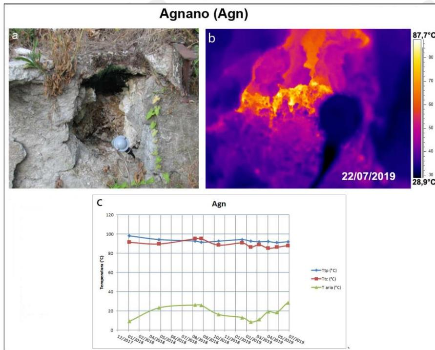
**Figura 3.2.3** – Fumarola all’interno dello stabilimento termale delle “Terme di Agnano”. Immagini nel visibile (a) e termica (b) riprese dal punto stazione Agn di figura 3.2.1c. Valori massimi di temperatura con termocamera (Ttc) e valori di temperatura dalla termocoppia (Ttp), confrontati con la temperatura dell’aria misurata nel momento del rilievo termico, da gennaio 2018 a luglio 2019 (c).
