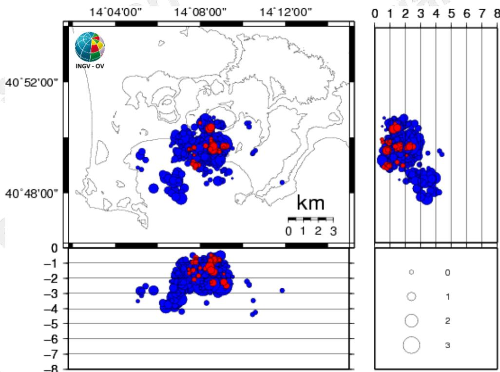
**Figura 3.1** - Ipocentri dei terremoti localizzati ai Campi Flegrei negli ultimi 12 mesi (in totale 1474). In rosso gli eventi localizzati nell'ultima settimana (in totale 39).
