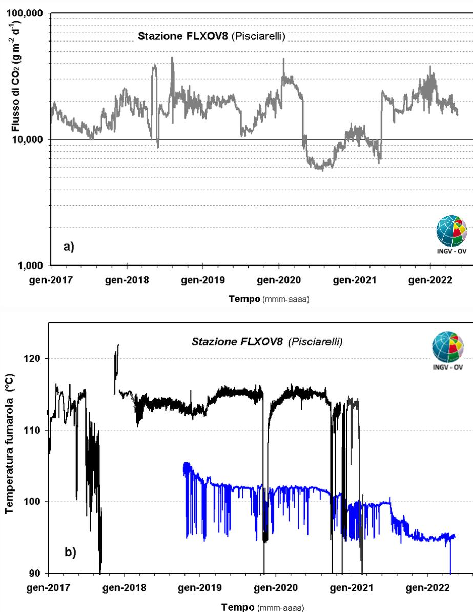
**Figura 5.1** - (a) Valori del flusso di CO<sub>2</sub> dal suolo (medie giornaliere); (b) dettaglio della temperatura della fumarola principale e di un'altra emissione fumarolica (linea blu) misurati in area Pisciarelli.
