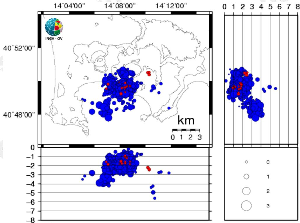
**Figura 3.1** - Ipocentri dei terremoti localizzati ai Campi Flegrei negli ultimi 12 mesi (in totale 1331). In rosso gli eventi localizzati nell'ultima settimana (in totale 18).
