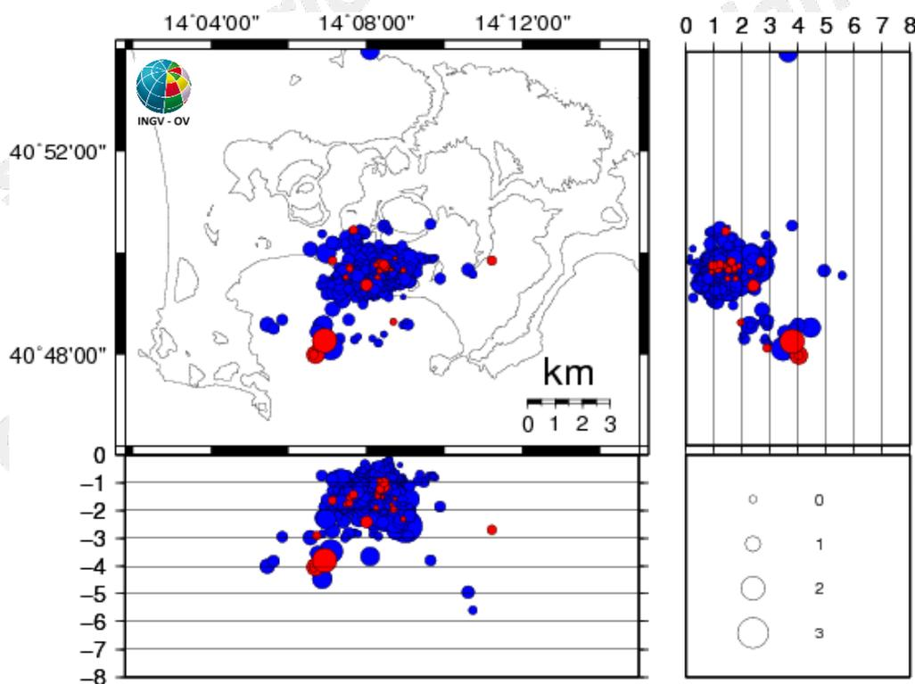
**Figura 3.1** - Ipocentri dei terremoti localizzati ai Campi Flegrei negli ultimi 12 mesi (in totale 1002). In rosso gli eventi localizzati nell'ultima settimana (in totale 25).
