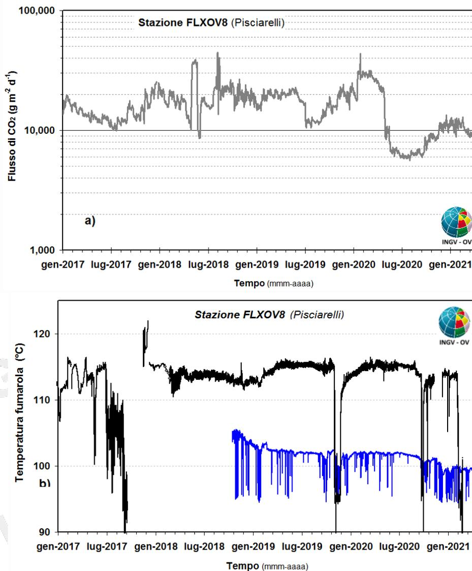
**Figura 5.1** - (a) Valori del flusso di CO<sub>2</sub> dal suolo (medie giornaliere); (b) dettaglio della temperatura della fumarola principale e di un'altra emissione fumarolica (linea blu) misurati in area Pisciarelli.
