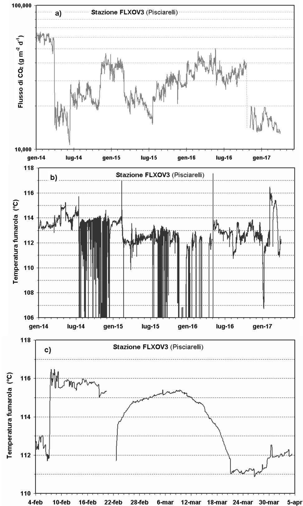
**Figura 3.1** - (a) Valori del flusso di CO<sub>2</sub> al suolo (medie giornaliere) e (b) della temperatura della fumarola principale registrati nel sito di Pisciarelli. (c) Dettaglio della temperatura della fumarola dal 4 febbraio.
