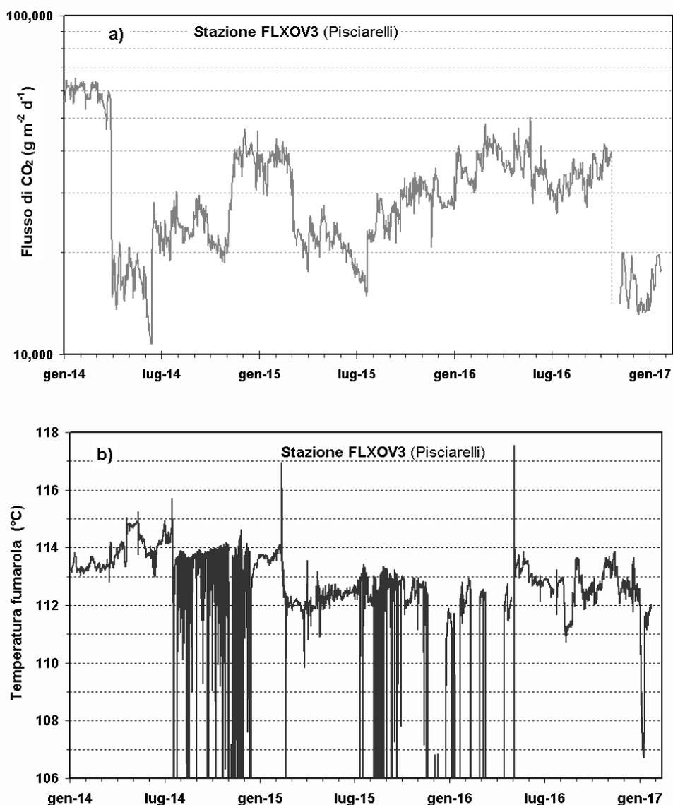
**Figura 4** - (a) Valori del flusso di CO<sub>2</sub> al suolo (medie giornaliere) e (b) della temperatura della fumarola principale registrati nel sito di Pisciarelli.
