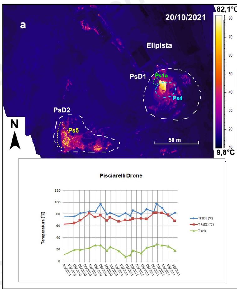
**Figura 3.2.2** – Fotocomposizione di immagini termiche rilevate da drone nel mese di ottobre 2021 (a) e valori massimi di temperatura (T) delle aree a maggiore anomalia termica (PsD1 e PsD2) confrontati con la temperatura dell'aria (Taria) misurata nel momento del rilievo termico da marzo 2020 a ottobre 2021 (b).
