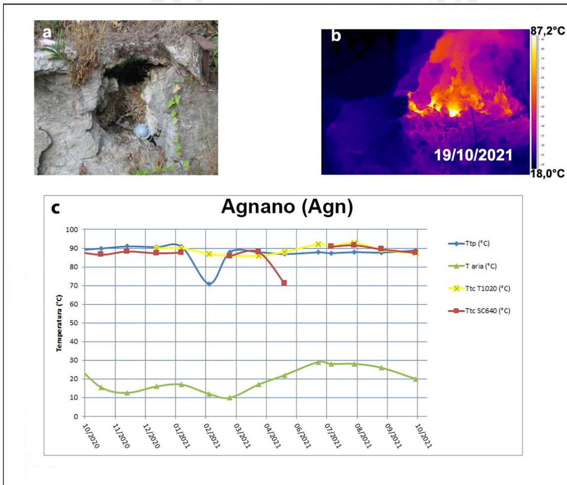
**Figura 3.2.5** – Fumarola all’interno dello stabilimento termale delle “Terme di Agnano”. Immagini nel visibile (a) e termica (b) riprese dal punto stazione Agn di figura 3.2.1c. Valori massimi di temperatura con termocamera FLIR SC640 (TtcSC640), valori massimi di temperatura con termocamera FLIR T1020 (TtcT1020) e valori di temperatura dalla termocoppia (Ttp), confrontati con la temperatura dell’aria (Taria) misurata nel momento del rilievo termico, da ottobre 2020 a ottobre 2021 (c).
