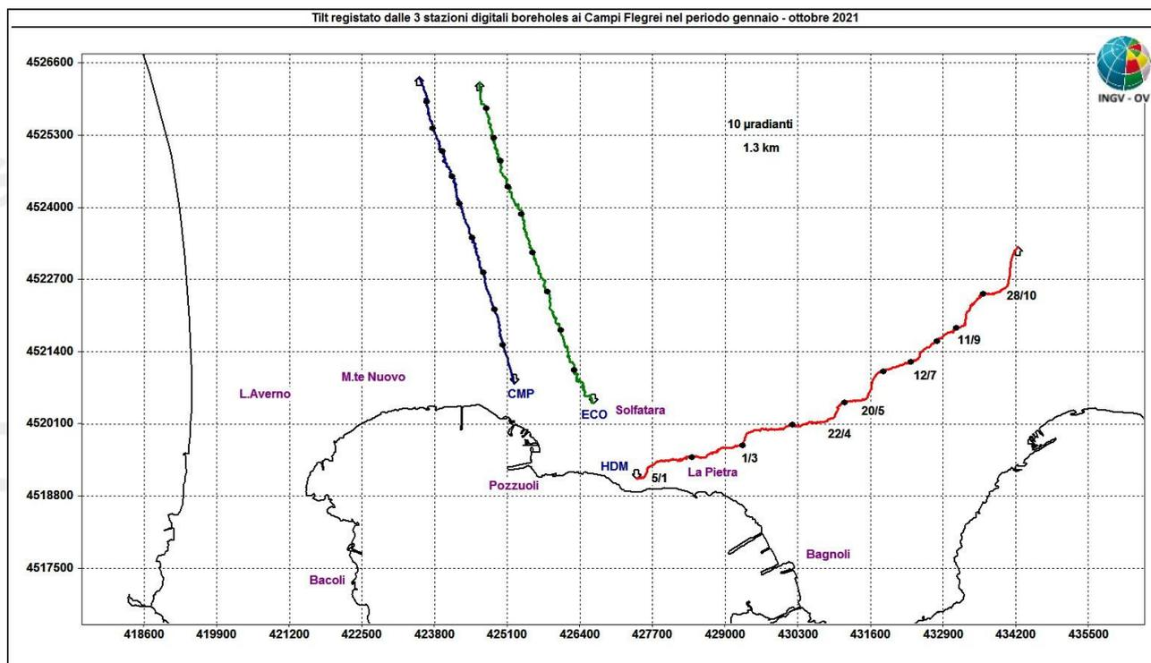
**Figura 2.2.2** - Pattern tiltmetrico osservato ai Campi Flegrei. Per comodità di rappresentazione grafica e per una interpretazione più agevole, sono riportate solo le 3 stazioni “borehole” con sensori ubicati a 25 m di profondità. Il lato di ogni maglia del reticolo equivale a 10  $\mu$ radianti o 1.3 km ed i pallini neri sovrapposti sui vettori tilt indicano intervalli di un mese. Le date riportate sui segnali indicano le variazioni tiltmetriche osservate più significative.
