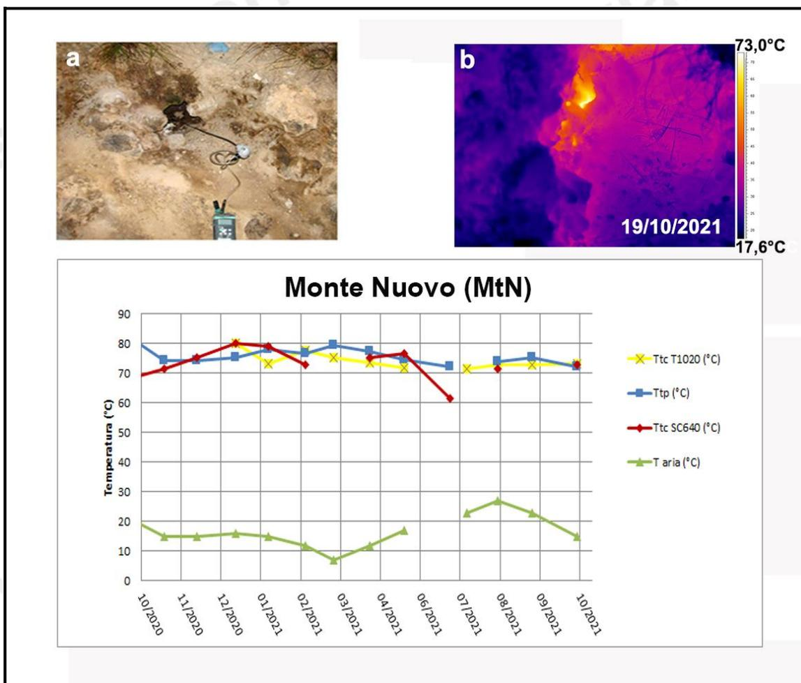
**Figura 3.2.4** – Fumarola lungo il versante meridionale di Monte Nuovo. Immagini nel visibile (a) e termica (b) riprese dal punto MtN di figura 1.1e. Valori massimi di temperatura con termocamera FLIR SC640 (TtcSC640), valori massimi di temperatura con termocamera FLIR T1020 (TtcT1020) e valori di temperatura dalla termocoppia (Ttp), confrontati con la temperatura dell'aria (Taria) misurata nel momento del rilievo termico, da ottobre 2020 a ottobre 2021 (c).
