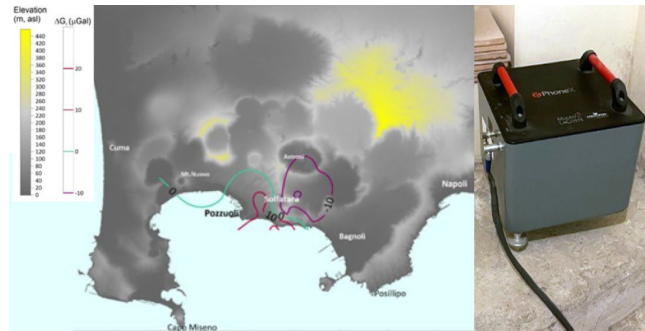
Mappa dei residui \Delta gr (a sinistra) e sensore gravimetrico relativo in continuo (a destra)
