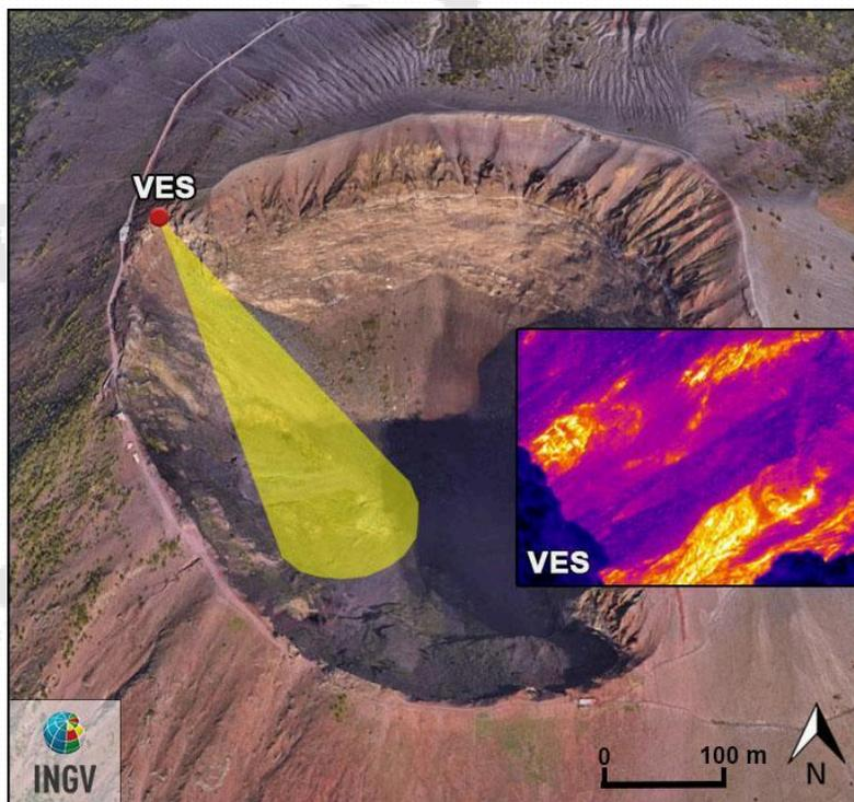
**Figura 3.1.1** - Ubicazione della stazione della Rete Permanente di Monitoraggio Termico ad immagine (TIRNet) operante al Vesuvio. Punto rosso: posizione della stazione; area in giallo: area acquisita.
