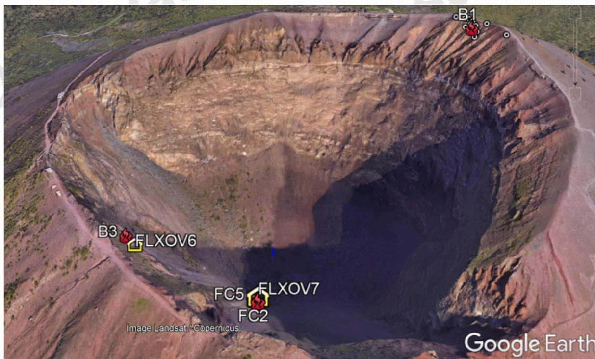
**Figura 4.1** - Ubicazione delle stazioni multiparametriche FLXOV6 e FLXOV7, e dei siti oggetto delle attività di sorveglianza geochimica in area craterica. In particolare, sono riportate le principali fumarole di bordo cratere (B1-B3) e di fondo cratere (FC2, FC5), sono inoltre riportati i punti fissi per la misura del flusso di CO<sub>2</sub> dal suolo e della temperatura del suolo, in area bordo cratere (simboli bianchi).
