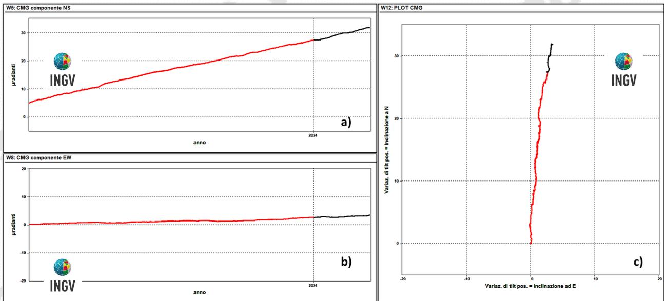
**Figura 2.2.2** – Serie temporali e plot del tilt della stazione CMG della rete del Vesuvio registrati negli ultimi 12 mesi (dal 1 marzo 2023 al 29 febbraio 2024).
