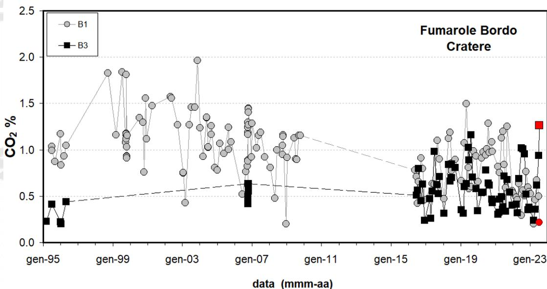
**Figura 4.4** - Cronogramma della concentrazione di CO<sub>2</sub> delle fumarole di bordo cratere B1 (area anemometro) e B3 (settore SW). I campioni delle fumarole B1 e B3 del mese di luglio 2023 sono riportati con il simbolo rosso.
