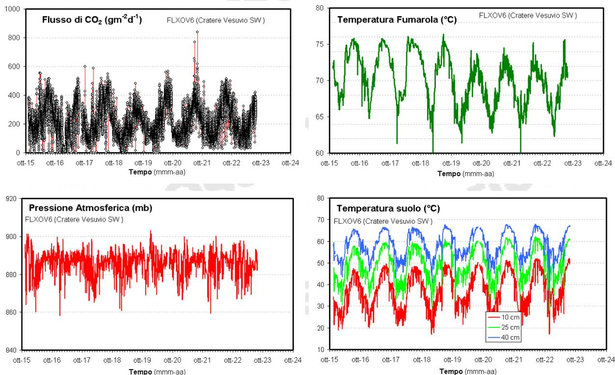
**Figura 4.5** - Parametri misurati dalla stazione geochimica (FLXOV6) installata in area bordo cratere del Vesuvio (settore SW). I valori, eccetto il flusso di CO<sub>2</sub> dal suolo, sono riportati come medie giornaliere.
