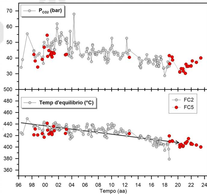
Figura 4.3 Cronogramma dei valori d'equilibrio della temperatura e pressione parziale di CO<sub>2</sub> stimati per il sistema idrotermale del Vesuvio sulla base della composizione della fumarola FC2 (simboli grigi) e FC5 (simboli rossi). Le stime per entrambe le fumarole indicano una diminuzione nel tempo dei valori d'equilibrio.
