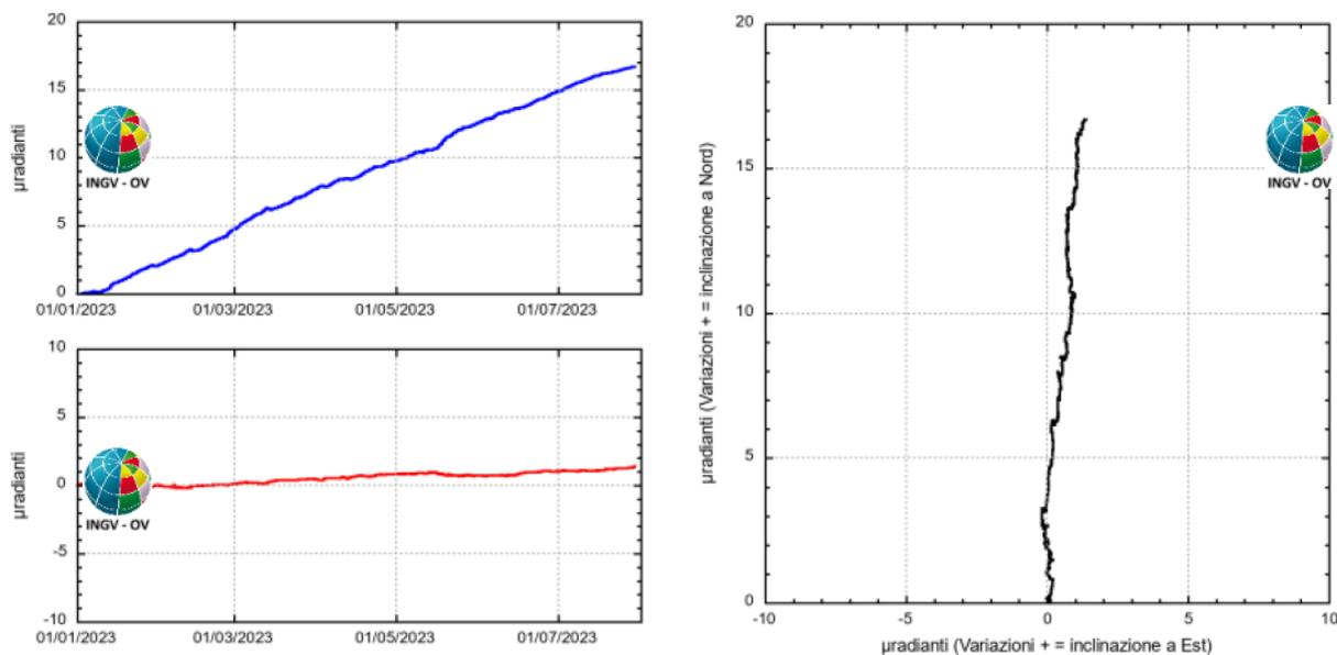
**Figura 2.2.2** – Serie temporali e plot del tilt della stazione CMG della rete del Vesuvio da gennaio a luglio 2023.
