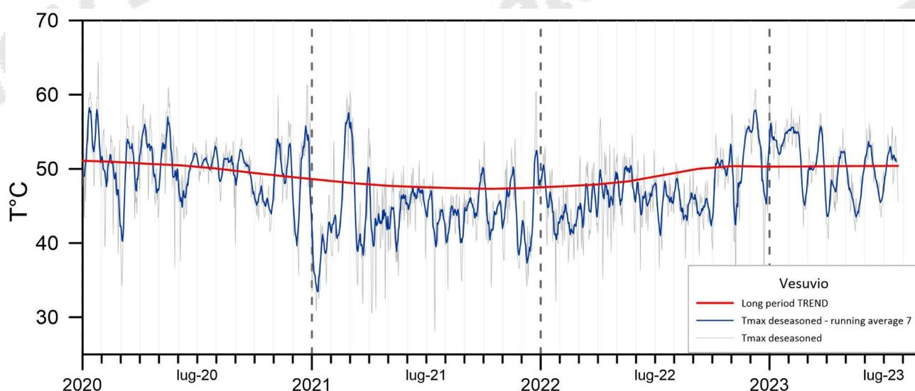
**Figura 3.1.2** - Stazione Vesuvio VES1. Serie temporali dei valori di temperatura massima giornaliera rilevata nelle immagini IR, destagionalizzate mediante applicazione dell'algoritmo BR (medie settimanali termocamera 640x480).
