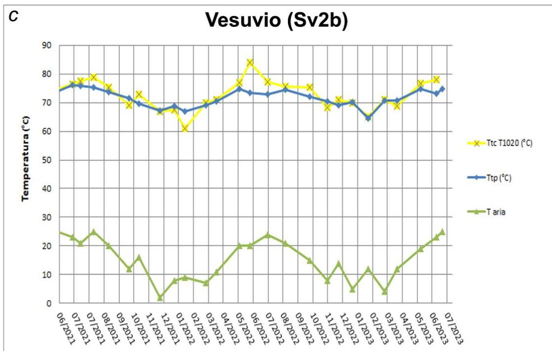
**Figura 3.2.2** - Immagini nel visibile (a) e termica (b) riprese al punto SV2b di Figura 3.2.1, di una fumarola ubicata sul settore occidentale del cratere del Vesuvio. Valori massimi di temperatura rilevati con la termocamera FLIR T1020 (TtcT1020) e con la termocoppia (Ttp), confrontati con la temperatura dell'aria (Taria) misurata nel momento del rilievo termico, da giugno 2021 a luglio 2023 (c).
