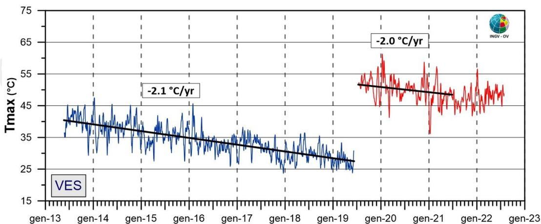
**Figura 3.1.2** - Stazione Vesuvio VES1. Serie temporali dei valori di temperatura massima giornaliera rilevata nelle immagini IR destagionalizzate mediante applicazione dell'algorithmo BR [medie settimanali termocamera 320x240 (blu); medie settimanali termocamera 640x480 (rosso)]; fit lineare (nero).
