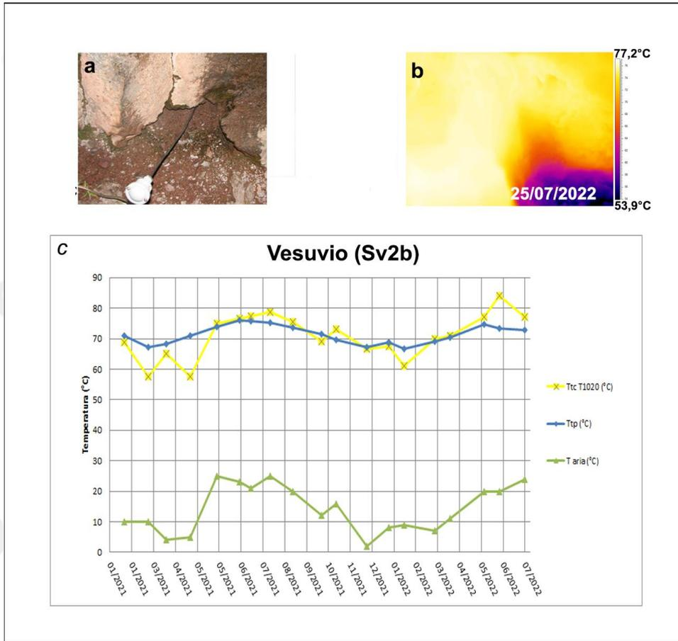
**Figura 3.2.2** – Immagini nel visibile (a) e termica (b) riprese al punto SV2b di Figura 3.2.1, di una fumarola ubicata sul settore occidentale del cratere del Vesuvio. Valori massimi di temperatura con termocamera FLIR SC640 (TtcSC640), valori massimi di temperatura con termocamera FLIR T1020 (TtcT1020) e valori di temperatura dalla termocoppia (Ttp), confrontati con la temperatura dell’aria (Taria) misurata nel momento del rilievo termico, da gennaio 2021 a luglio 2022 (c).
