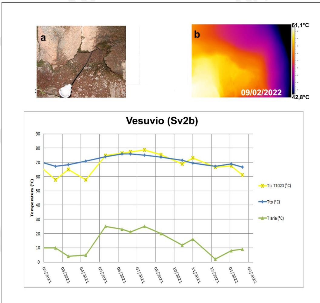
**Figura 3.2.2** – Immagini nel visibile (a) e termica (b) riprese al punto SV2b di Figura 3.2.1, di una fumarola ubicata sul settore occidentale del cratere del Vesuvio. Valori massimi di temperatura con termocamera FLIR SC640 (TtcSC640), valori massimi di temperatura con termocamera FLIR T1020 (TtcT1020) e valori di temperatura dalla termocoppia (Ttp), confrontati con la temperatura dell’aria (Taria) misurata nel momento del rilievo termico, da febbraio 2021 a febbraio 2022 (c).
