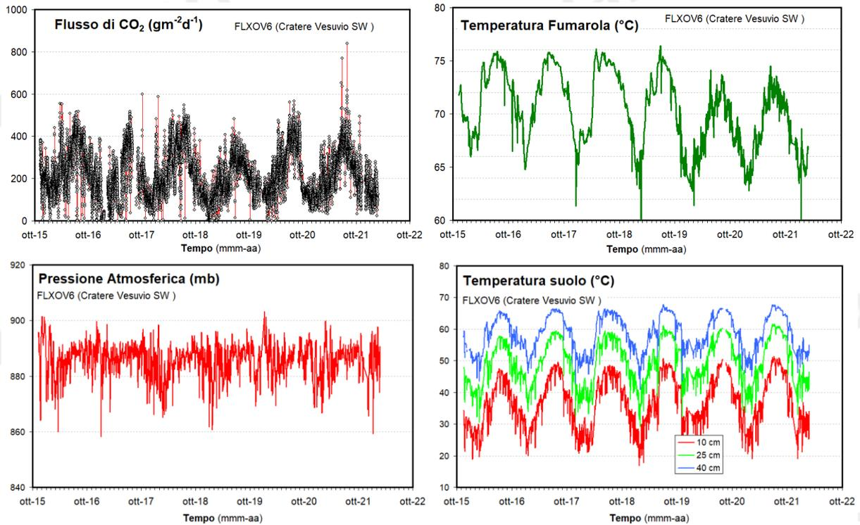
**Figura 4.2** - Parametri misurati dalla stazione geochimica (FLXOV6) installata in area bordo cratere del Vesuvio (settor SW). I valori, eccetto il flusso di CO<sub>2</sub> dal suolo, sono riportati come medie giornaliere.
