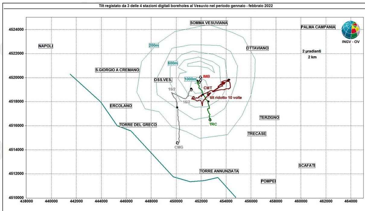
**Figura 2.2.2** – Pattern tiltmetrico osservato al Vesuvio. Per comodità di rappresentazione grafica e per una interpretazione più agevole, sono state selezionate in tale figura solo le 4 stazioni “borehole” con sensori ubicati a 25 m di profondità. Il lato di ogni maglia del reticolo equivale a 2  $\mu$ radianti o 2 km. Inoltre, per esigenze grafiche, il tilt registrato a CMT è ridotto 10 volte.
