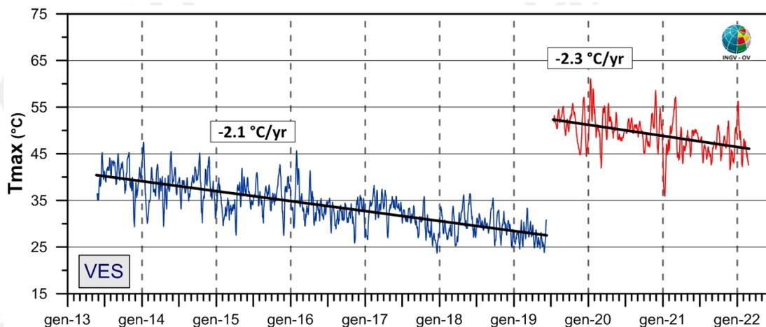
**Figura 3.1.2** - Stazione Vesuvio VES1. Serie temporali dei valori di temperatura massima giornaliera rilevata nelle immagini IR destagionalizzate mediante applicazione dell'algoritmo BR [medie settimanali termocamera 320x240 (blu); medie settimanali termocamera 640x480 (rosso)]; fit lineare (nero).
