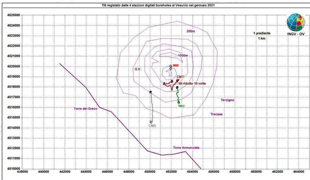
**Figura 2.2.2** – Pattern tiltmetrico osservato al Vesuvio. Per comodità di rappresentazione grafica e per una interpretazione più agevole, sono state selezionate in tale figura solo le 4 stazioni “borehole” con sensori ubicati a 25 m di profondità. Il lato di ogni maglia del reticolo equivale a 1  $\mu$ radiante o 1 km. Inoltre, per esigenze grafiche, il tilt registrato a CMT è ridotto 10 volte.
