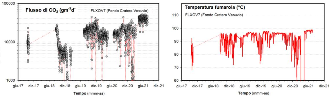
**Figura 4.4** - Parametri misurati dalla stazione geochimica (FLXOV7) installata in area di fondo cratere del Vesuvio. I valori, eccetto il flusso di CO<sub>2</sub> dal suolo, sono riportati come medie giornaliere.
