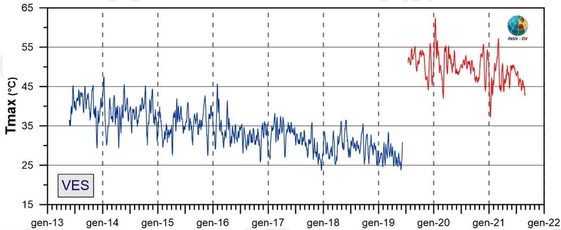
**Figura 3.1.2** - Stazione Vesuvio VES1. Serie temporali dei valori di temperatura massima giornaliera rilevata nelle immagini IR destagionalizzate mediante applicazione dell' algoritmo BR [medie settimanali termocamera 320x240 (blu); medie settimanali termocamera 640x480 (rosso)].
