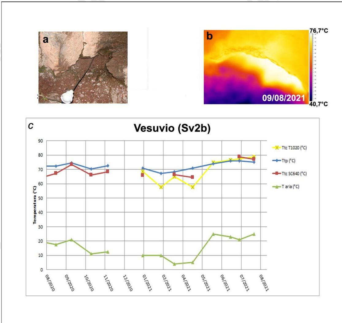
**Figura 3.2.2** – Immagini nel visibile (a) e termica (b) riprese al punto SV2b di Figura 3.2.1, di una fumarola ubicata sul settore occidentale del cratere del Vesuvio. Valori massimi di temperatura con termocamera FLIR SC640 (TtcSC640), valori massimi di temperatura con termocamera FLIR T1020 (TtcT1020) e valori di temperatura dalla termocoppia (Ttp), confrontati con la temperatura dell’aria (Taria) misurata nel momento del rilievo termico, da agosto 2020 ad agosto 2021 (c).
