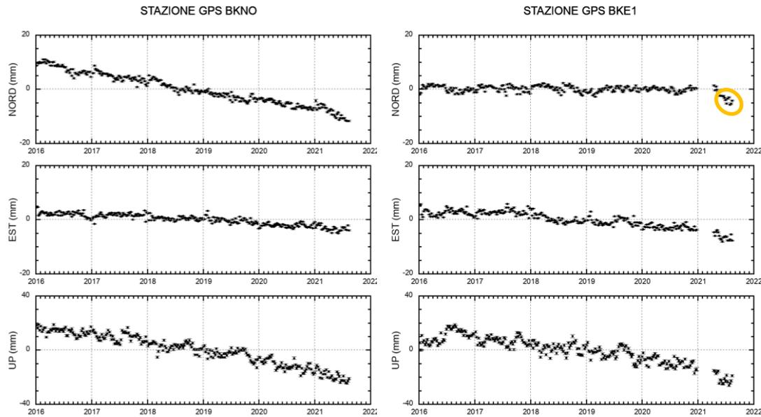
**Figura 2.1.3** - Serie temporale delle variazioni settimanali lungo le tre componenti (Nord, Est e Quota) delle stazioni di BKNO e BKE1 (Vesuvio) da gennaio 2016 ad agosto 2021.
