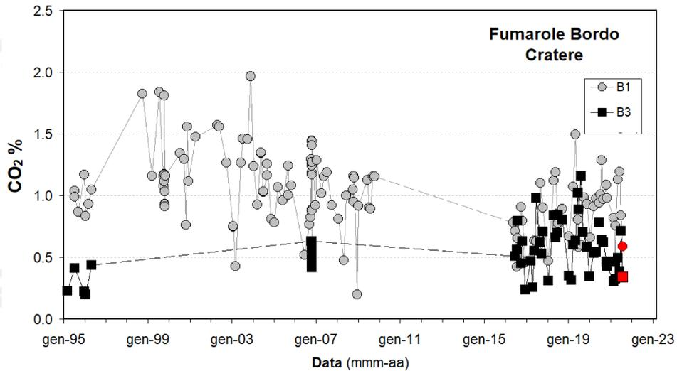
**Figura 4.2** - Cronogramma della concentrazione di CO<sub>2</sub> delle fumarole di bordo cratere B1 (area anemometro) e B3 (settore SW). I campioni del mese di agosto 2021 sono riportati con il simbolo rosso.
