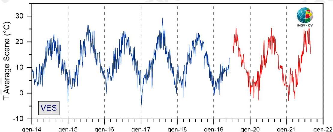
**Figura 3.1.3** - Stazione Vesuvio VES1: Serie temporale dei valori di temperatura media di ogni immagine acquisita con la precedente stazione (linea blu) e con quella di recente installazione (linea rossa).
