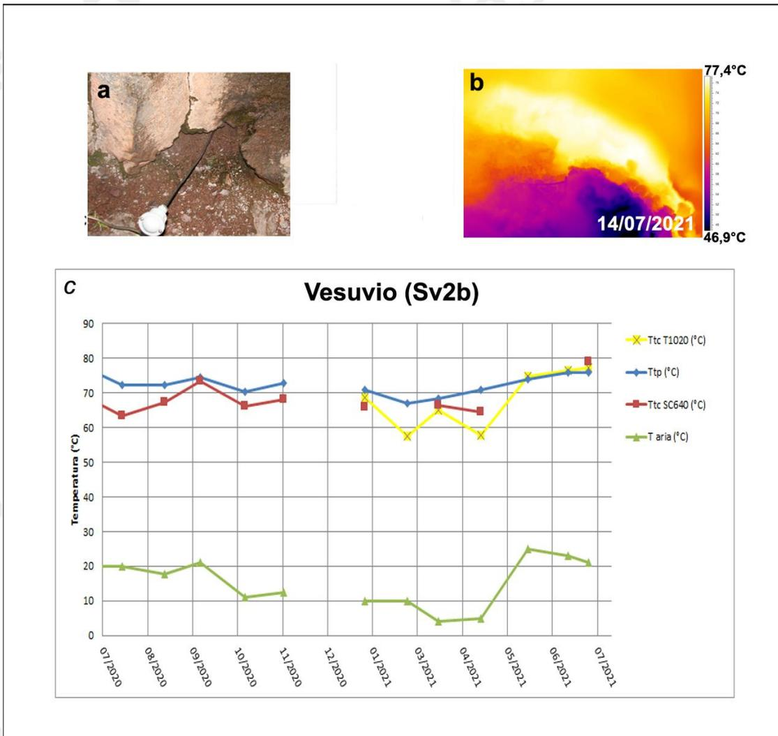
**Figura 3.2.2** – Immagini nel visibile (a) e termica (b) riprese al punto SV2b di Figura 3.2.1, di una fumarola ubicata sul settore occidentale del cratere del Vesuvio. Valori massimi di temperatura con termocamera FLIR SC640 (TtcSC640), valori massimi di temperatura con termocamera FLIR T1020 (TtcT1020) e valori di temperatura dalla termocoppia (Ttp), confrontati con la temperatura dell'aria (Taria) misurata nel momento del rilievo termico, da luglio 2020 a luglio 2021 (c).
