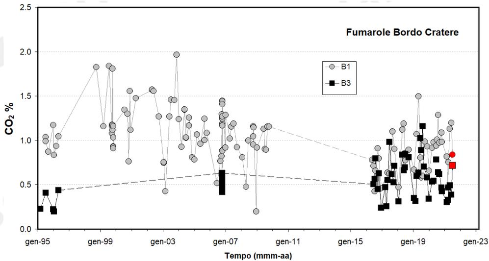
**Figura 4.2** - Cronogramma della concentrazione di CO<sub>2</sub> delle fumarole di bordo cratere B1 (area anemometro) e B3 (settore SW). I campioni del mese di aprile 2021 sono riportati con il simbolo rosso.
