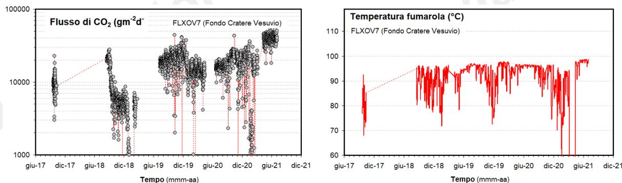
**Figura 4.4** - Parametri misurati dalla stazione geochimica (FLXOV7) installata in area di fondo cratere del Vesuvio. I valori, eccetto il flusso di CO<sub>2</sub> dal suolo, sono riportati come medie giornaliere.
