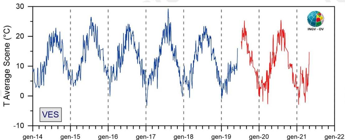
**Figura 3.1.3** - Stazione Vesuvio VES1: Serie temporale dei valori di temperatura media di ogni immagine acquisita con la precedente stazione (linea nera) e con quella di recente installazione (linea rossa).
