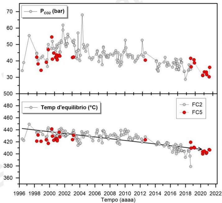
**Figura 4.3** - Cronogramma dei valori d'equilibrio della temperatura e pressione parziale di CO<sub>2</sub> stimati per il sistema idrotermale del Vesuvio sulla base della composizione della fumarola FC2 (simboli grigi) e FC5 (simboli rossi). Le stime per entrambe le fumarole indicano una diminuzione nel tempo dei valori d'equilibrio.
