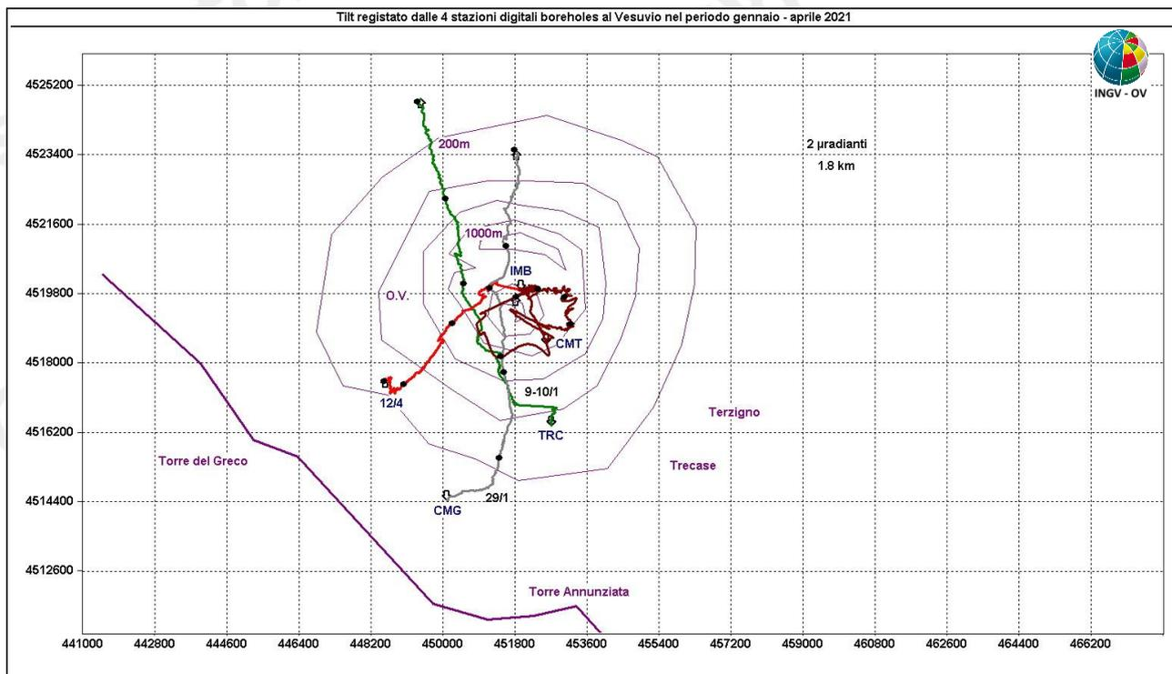
**Figura 2.2.2** – Pattern tiltmetrico osservato al Vesuvio. Per comodità di rappresentazione grafica e per una interpretazione più agevole, sono state selezionate in tale figura solo le 4 stazioni “borehole” con sensori ubicati a 25 m di profondità. Il lato di ogni maglia del reticolo equivale a 2  $\mu$ radianti o 1.8 km ed i pallini neri sovrapposti sui vettori tilt indicano intervalli di 1 mese.
