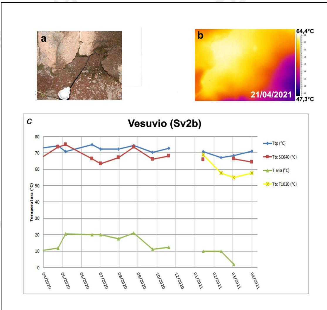
**Figura 3.2.2** – Immagini nel visibile (a) e termica (b) riprese al punto SV2b di Figura 3.2.1, di una fumarola ubicata sul settore occidentale del cratere del Vesuvio. Valori massimi di temperatura con termocamera FLIR SC640 (TtcSC640), valori massimi di temperatura con termocamera FLIR T1020 (TtcT1020) e valori di temperatura dalla termocoppia (Ttp), confrontati con la temperatura dell'aria (Taria) misurata nel momento del rilievo termico, da aprile 2020 a aprile 2021 (c).
