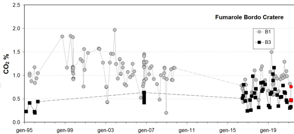
**Figura 4.4** - Cronogramma della concentrazione di CO<sub>2</sub> delle fumarole di bordo cratere B1 (area anemometro) e B3 (settore SW). I campioni del mese di aprile 2021 sono riportati con il simbolo rosso.
