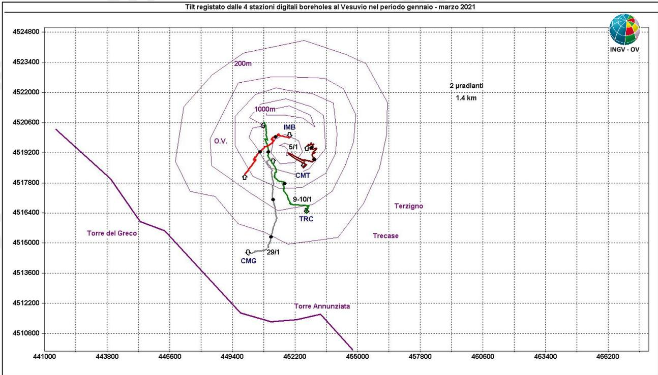
**Figura 2.2.2** – Pattern tiltmetrico osservato al Vesuvio. Per comodità di rappresentazione grafica e per una interpretazione più agevole, sono state selezionate in tale figura solo le 4 stazioni “borehole” con sensori ubicati a 25 m di profondità. Il lato di ogni maglia del reticolo equivale a 2  $\mu$ radianti o 1.4 km ed i pallini neri sovrapposti sui vettori tilt indicano intervalli di 1 mese.
