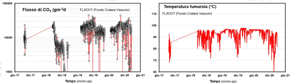
**Figura 4.6** - Parametri misurati dalla stazione geochimica (FLXOV7) installata in area di fondo cratero del Vesuvio. I valori, eccetto il flusso di CO<sub>2</sub> dal suolo, sono riportati come medie giornaliere.
