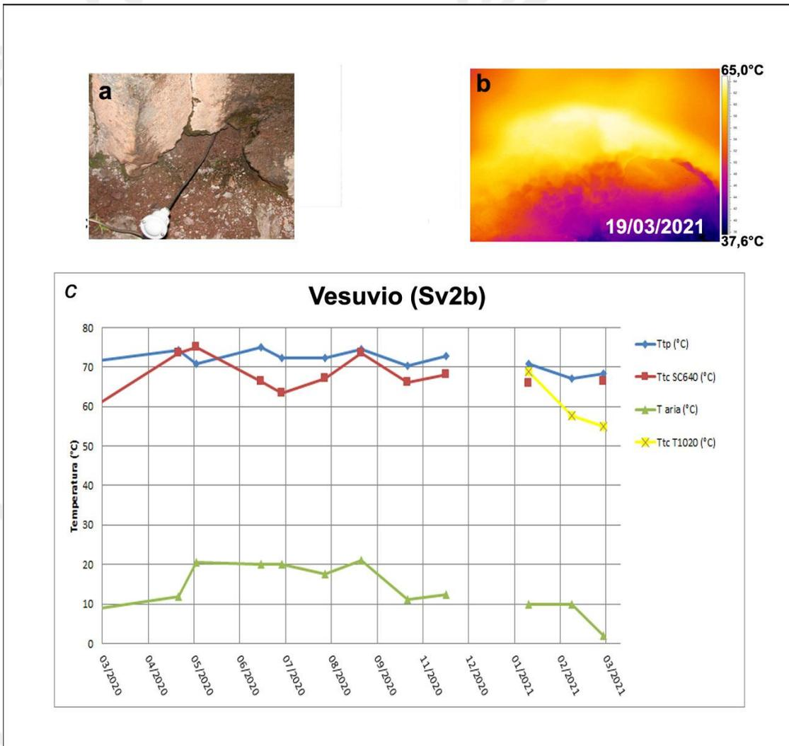
**Figura 3.2.2** – Immagini nel visibile (a) e termica (b) riprese al punto SV2b di Figura 3.2.1, di una fumarola ubicata sul settore occidentale del cratere del Vesuvio. Valori massimi di temperatura con termocamera FLIR SC640 (TtcSC640), valori massimi di temperatura con termocamera FLIR T1020 (TtcT1020) e valori di temperatura dalla termocoppia (Ttp), confrontati con la temperatura dell'aria (Taria) misurata nel momento del rilievo termico, da marzo 2020 a marzo 2021 (c).
