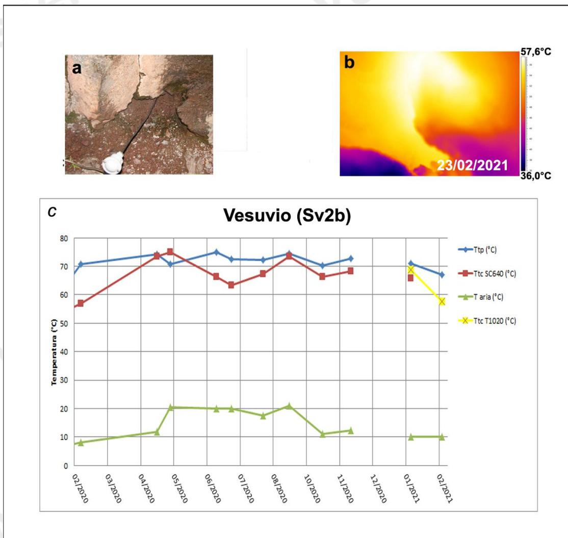
**Figura 3.2.2** – Immagini nel visibile (a) e termica (b) riprese al punto SV2b di Figura 3.2.1, di una fumarola ubicata sul settore occidentale del cratere del Vesuvio. Valori massimi di temperatura con termocamera FLIR SC640 (TtcSC640), valori massimi di temperatura con termocamera FLIR T1020 (TtcT1020) e valori di temperatura dalla termocoppia (Ttp), confrontati con la temperatura dell'aria misurata nel momento del rilievo termico, da febbraio 2020 a febbraio 2021 (c).
