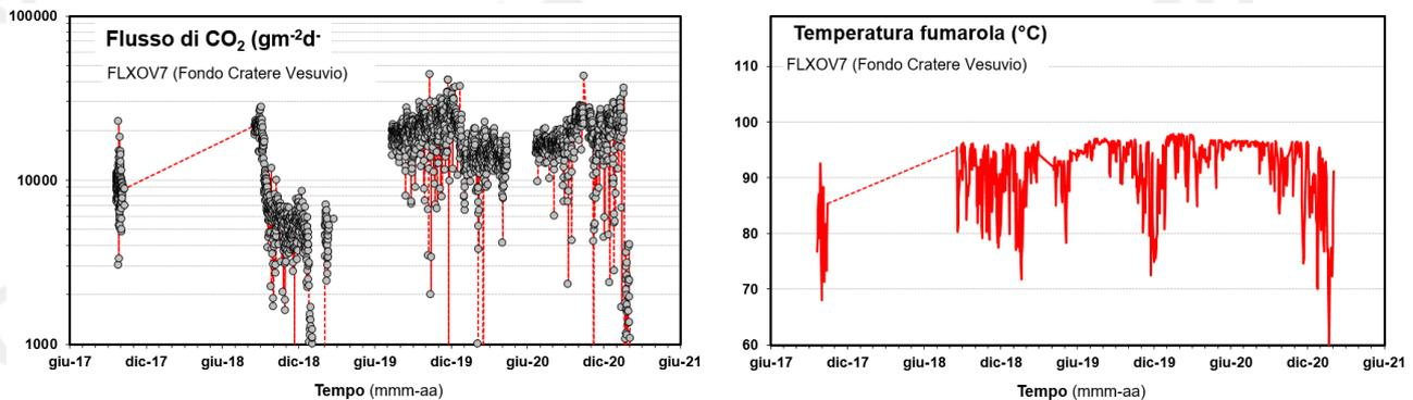
**Figura 4.4** - Parametri misurati dalla stazione geochimica (FLXOV7) installata in area di fondo cratero del Vesuvio. I valori, eccetto il flusso di CO<sub>2</sub> dal suolo, sono riportati come medie giornaliere.
