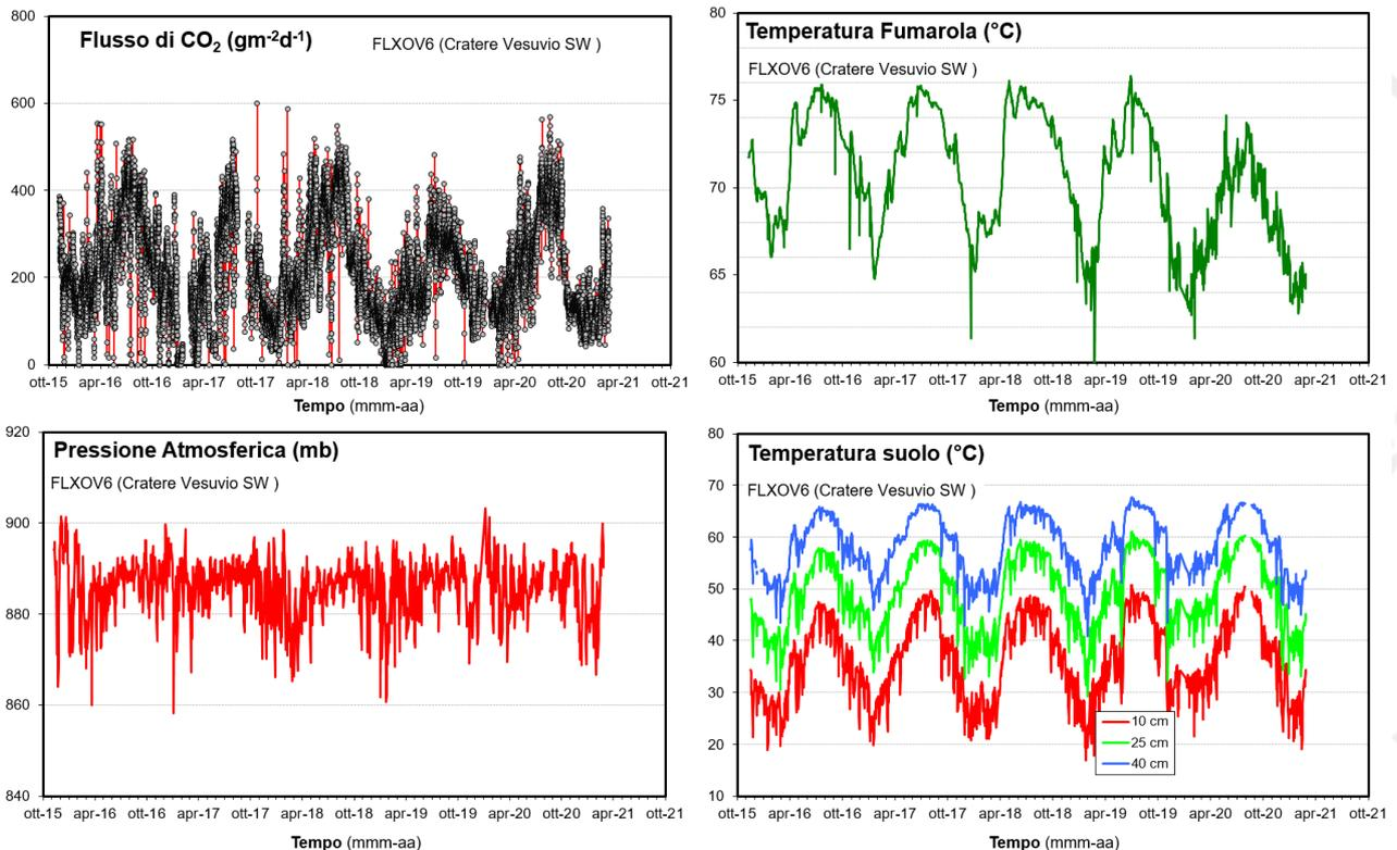
**Figura 4.3** - Parametri misurati dalla stazione geochimica (FLXOV6) installata in area bordo cratere del Vesuvio (settore SW). I valori, eccetto il flusso di CO<sub>2</sub> dal suolo, sono riportati come medie giornaliere.
