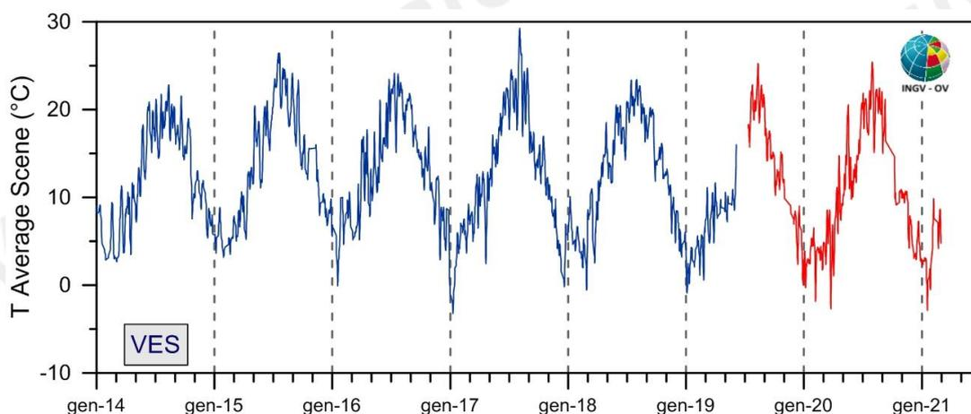
**Figura 3.1.3** - Stazione Vesuvio VES1: Serie temporale dei valori di temperatura media di ogni immagine acquisita con la precedente stazione (linea nera) e con quella di recente installazione (linea rossa).
