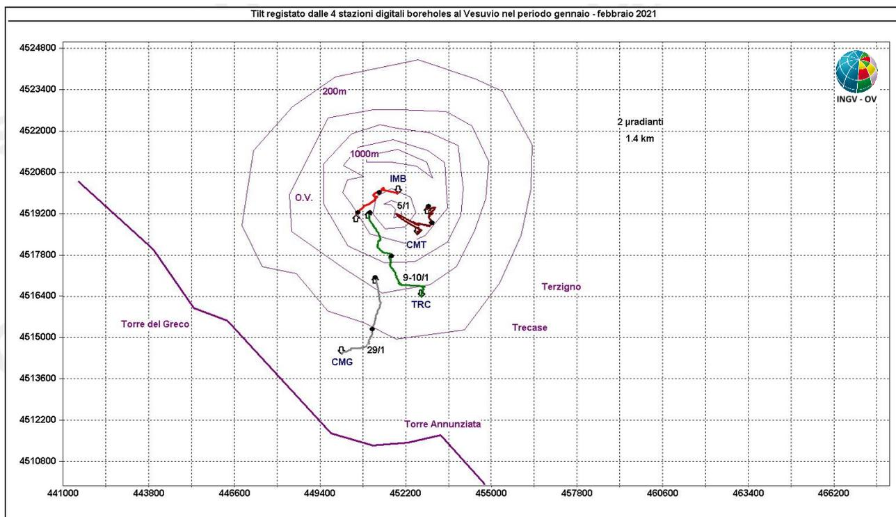
**Figura 2.2.2** – Pattern tiltmetrico osservato al Vesuvio. Per comodità di rappresentazione grafica e per una interpretazione più agevole, sono state selezionate in tale figura solo le 4 stazioni “borehole” con sensori ubicati a 25 m di profondità. Il lato di ogni maglia del reticolo equivale a 2  $\mu$ radianti o 1.4 km.
