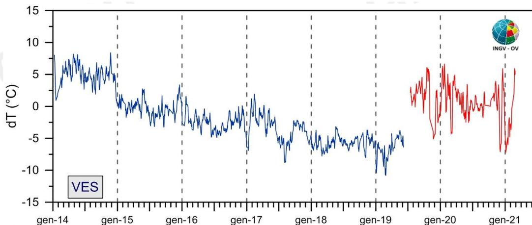
**Figura 3.1.2** - Stazione Vesuvio VES1. Serie temporali dei valori di temperatura massima giornaliera rilevata nelle immagini IR destagionalizzate mediante applicazione dell'algorithmo BR [medie settimanali termocamera 320x240 (blu); medie settimanali termocamera 640x480 (rosso)].
