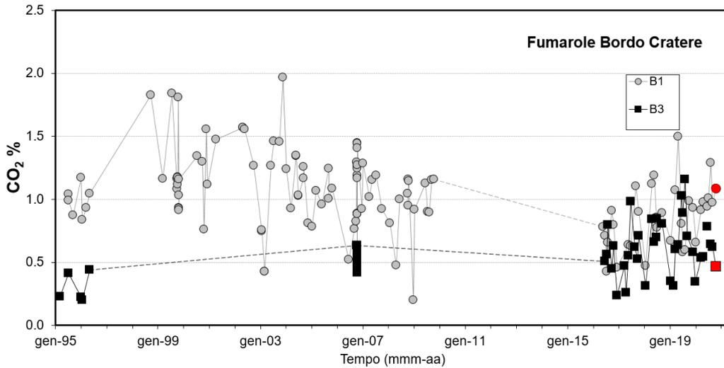
**Figura 4.2** - Cronogramma della concentrazione di CO<sub>2</sub> delle fumarole di bordo cratere B1 (area anemometro) e B3 (settore SW). I campioni del mese di febbraio 2021 sono riportati con il simbolo rosso.
