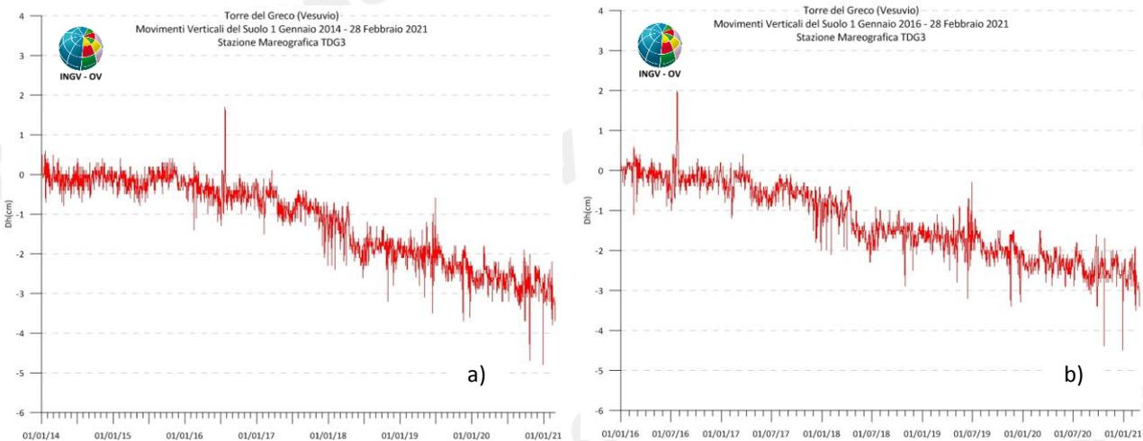
**Figura 2.3.2** - Movimenti verticali del suolo, nel periodo gennaio 2014 - febbraio 2021 (a) e gennaio 2016 - febbraio 2021 (b), ottenuti dall'analisi dei dati acquisiti dal sensore digitale alla stazione mareografica di Torre del Greco (TDG3). Le variazioni riportate rappresentano le medie giornaliere e sono riferite alla stazione di Napoli Molo S.Vincenzo (NAMM).
