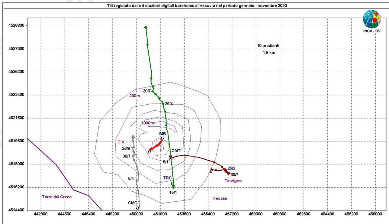
**Figura 2.2.2** – Pattern tiltmetrico osservato al Vesuvio. Per comodità di rappresentazione grafica e per una interpretazione più agevole, sono state selezionate in tale figura solo le 4 stazioni “borehole” con sensori ubicati a 25 m di profondità. Il lato di ogni maglia del reticolo equivale a 10  $\mu$ radianti o 1.8 km ed i pallini in colore sovrapposti sui vettori tilt indicano intervalli di 30 giorni.
