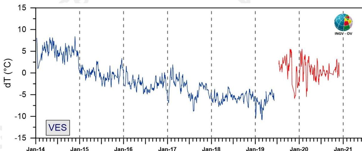
**Figura 3.1.2** - Stazione Vesuvio VES1. Serie temporali dei valori di temperatura massima rilevati nelle immagini IR destagionalizzate mediante applicazione dell’algoritmo BR [medie settimanali termocamera 320x240 (blu); medie settimanali termocamera 640x480 (rosso)].
