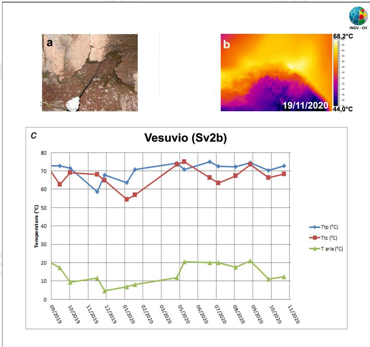
**Figura 3.2.2** – Immagini nel visibile (a) e termica (b) riprese al punto SV2b di Figura 3.2.1, di una fumarola ubicata sul settore occidentale del cratere del Vesuvio. Valori massimi di temperatura con termocamera (Ttc) e valori di temperatura dalla termocoppia (Ttp), confrontati con la temperatura dell'aria misurata nel momento del rilievo termico, da settembre 2019 a novembre 2020 (c).
