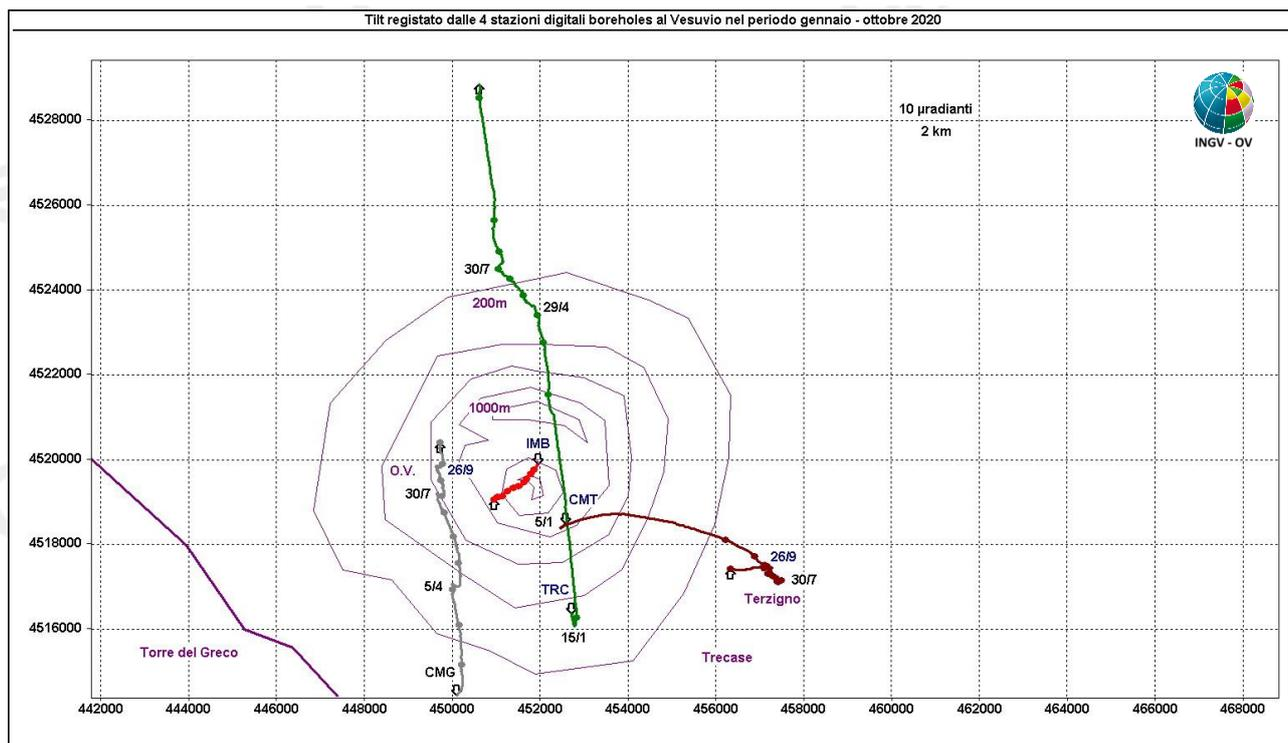
**Figura 2.2.2** – Pattern tiltmetrico osservato al Vesuvio. Per comodità di rappresentazione grafica e per una interpretazione più agevole, sono state selezionate in tale figura solo le 4 stazioni “borehole” con sensori ubicati a 25 m di profondità. Il lato di ogni maglia del reticolo equivale a 10  $\mu$ radianti o 2.0 km ed i pallini in colore sovrapposti sui vettori tilt indicano intervalli di 30 giorni.
