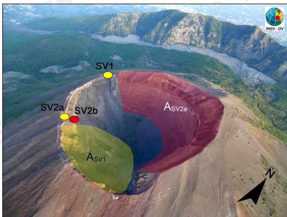
**Figura 3.2.1** – Cratere del Vesuvio. In giallo sono riportati i punti stazione dai quali vengono effettuati i rilievi termici con telecamera termica, in rosso quello nel quale vengono effettuati anche rilievi con termocoppia rigida. L'area in rosso (ASV2a) è quella ripresa dal punto stazione SV2a, mentre l'area in giallo (ASV1) è ripresa dal punto stazione SV1.
