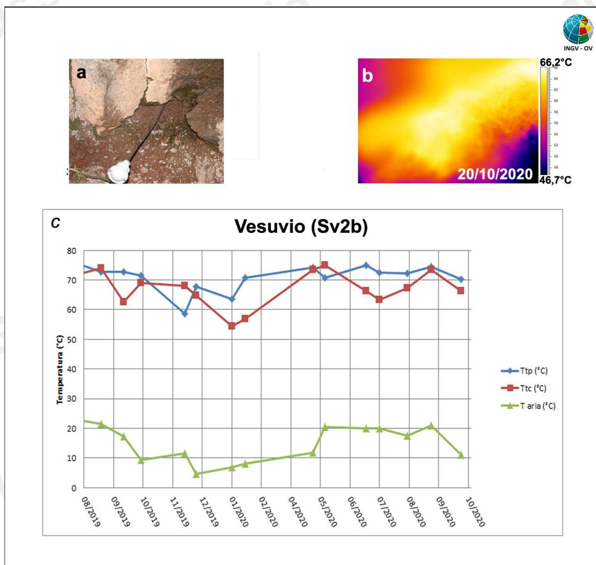
**Figura 3.2.2** – Immagini nel visibile (a) e termica (b) riprese al punto SV2b di Figura 3.2.1, di una fumarola ubicata sul settore occidentale del cratere del Vesuvio. Valori massimi di temperatura con termocamera (Ttc) e valori di temperatura dalla termocoppia (Ttp), confrontati con la temperatura dell'aria misurata nel momento del rilievo termico, da agosto 2019 a ottobre 2020 (c).
