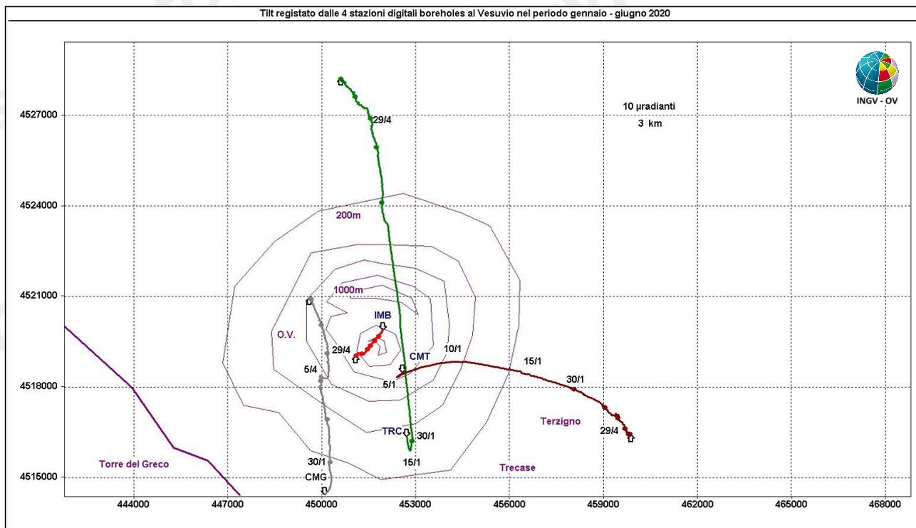
**Figura 2.2.2** – Pattern tiltmetrico osservato al Vesuvio. Per comodità di rappresentazione grafica e per una interpretazione più agevole, sono state selezionate in tale figura solo le 4 stazioni “borehole” con sensori ubicati a 25 m di profondità. Il lato di ogni maglia del reticolo equivale a 10  $\mu$ radianti o 3 km ed i pallini in colore sovrapposti sui vettori tilt indicano intervalli di 30 giorni.
