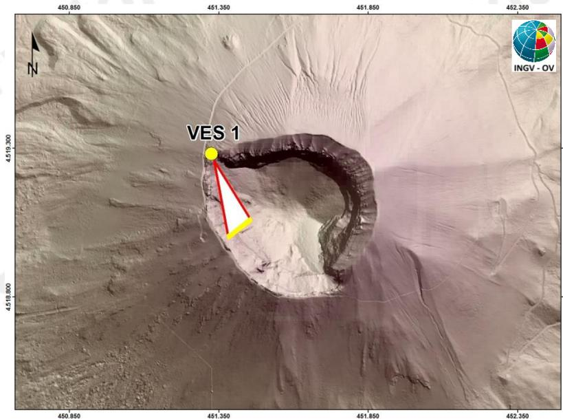
**Figura 3.1.1** - Mappa della Rete Permanente di Monitoraggio Termico ad immagine (TIRNet) operante al Vesuvio. Punto giallo: posizione della stazione; base del triangolo: area campionata.
