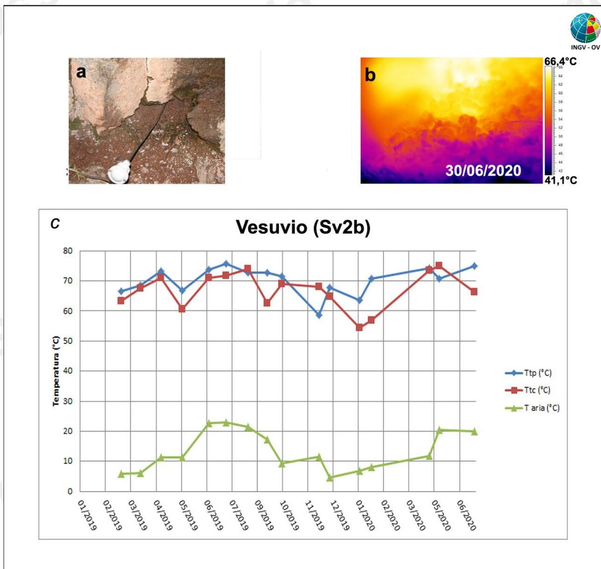
**Figura 3.2.2** – Immagini nel visibile (a) e termica (b) riprese al punto SV2b di Figura 3.2.1, di una fumarola ubicata sul settore occidentale del cratere del Vesuvio. Valori massimi di temperatura con termocamera (Ttc) e valori di temperatura dalla termocoppia (Ttp), confrontati con la temperatura dell'aria misurata nel momento del rilievo termico, da gennaio 2019 a giugno 2020 (c).
