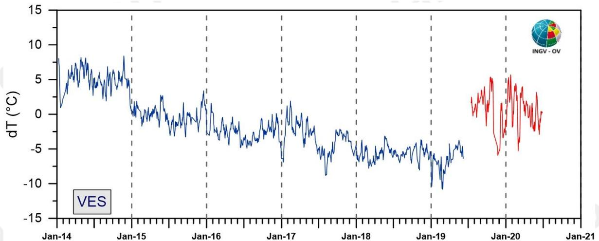
**Figura 3.1.2** - Stazione Vesuvio VES1. Serie temporali dei valori di temperatura massima rilevati nelle immagini IR destagionalizzate mediante applicazione dell' algoritmo BR [medie settimanali termocamera 320x240 (blu); medie settimanali termocamera 640x480 (rosso)].
