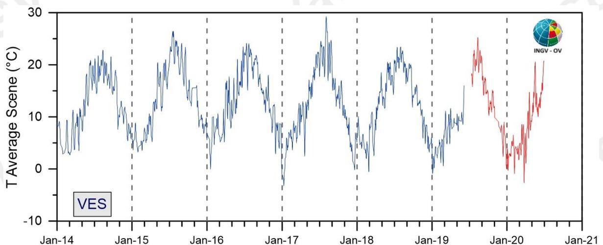
**Figura 3.1.3** - Stazione Vesuvio: Serie temporale dei valori medi di temperatura relativi ad ogni immagine acquisita con la precedente stazione (linea blu) e con quella di recente installazione (linea rossa).
