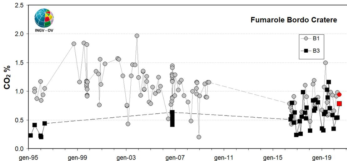
**Figura 4.2** - Cronogramma della concentrazione di CO<sub>2</sub> delle fumarole di bordo cratere B1 (area anemometro) e B3 (settore SW). I campioni del mese di giugno 2020 sono riportati con il simbolo rosso.
