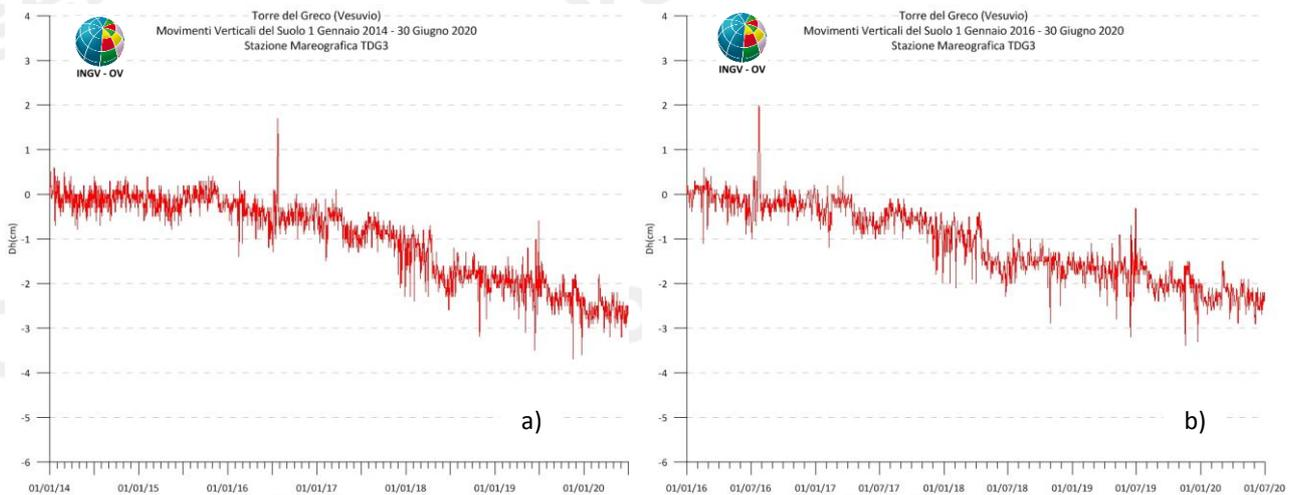
**Figura 2.3.2** - Movimenti verticali del suolo, nel periodo gennaio 2014 - giugno 2020 (a) e gennaio 2016 - giugno 2020 (b), ottenuti dall'analisi dei dati acquisiti dal sensore digitale alla stazione mareografica di Torre del Greco (TDG3). Le variazioni riportate rappresentano le medie giornaliere e sono riferite alla stazione di Napoli Molo S.Vincenzo (NAMM).
