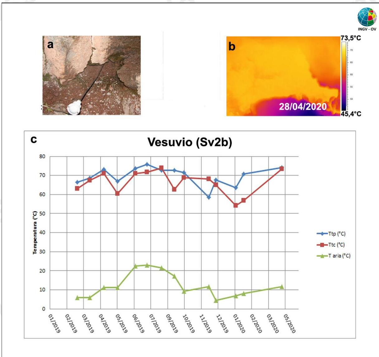
**Figura 3.2.2** – Immagini nel visibile (a) e termica (b) riprese al punto SV2b di Figura 3.2.1, di una fumarola ubicata sul settore occidentale del cratere del Vesuvio. Valori massimi di temperatura con termocamera (Ttc) e valori di temperatura dalla termocoppia (Ttp), confrontati con la temperatura dell'aria misurata nel momento del rilievo termico, da gennaio 2018 ad aprile 2020 (c).
