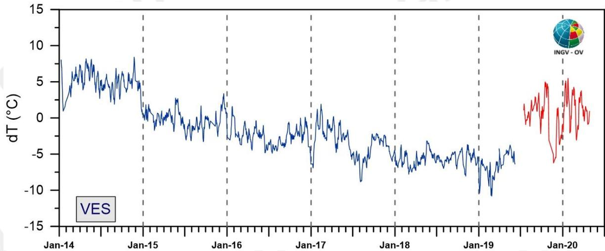
**Figura 3.1.2** - Stazione Vesuvio VES1. Serie temporali dei valori di temperatura massima rilevati nelle immagini IR destagionalizzate mediante applicazione dell'algorithmo BR [medie settimanali termocamera 320x240 (blu); medie settimanali termocamera 640x480 (rosso)].
