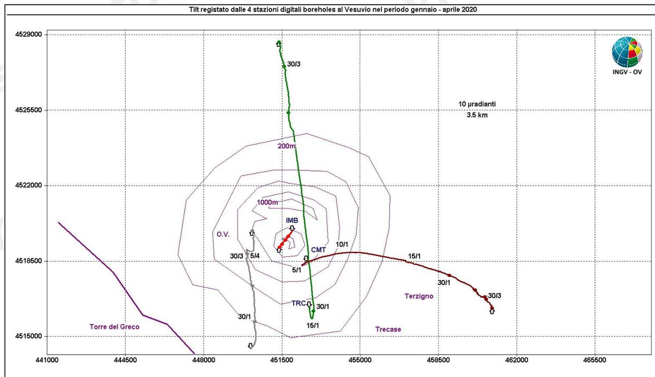
**Figura 2.2.2** – Pattern tiltmetrico osservato al Vesuvio. Per comodità di rappresentazione grafica e per una interpretazione più agevole, sono state selezionate in tale figura solo le 4 stazioni “borehole” con sensori ubicati a 25 m di profondità. Il lato di ogni maglia del reticolo equivale a 10  $\mu$ radianti o 3.5 km ed i pallini in colore sovrapposti sui vettori tilt indicano intervalli di 30 giorni.
