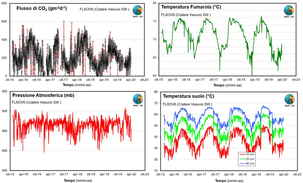
**Figura 4.3** - Parametri misurati dalla stazione geochimica (FLXOV6) installata in area bordo cratere del Vesuvio (sette SW). I valori, eccetto il flusso di CO<sub>2</sub> dal suolo, sono riportati come medie giornaliere.
