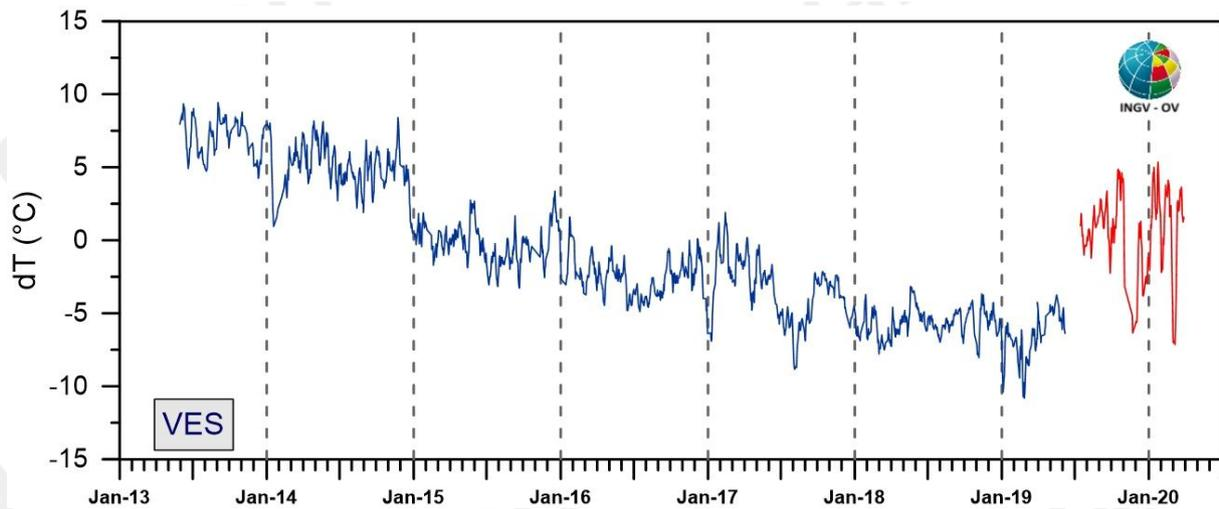
**Figura 3.1.2** - Stazione Vesuvio VES1. Serie temporali dei valori di temperatura massima rilevati nelle immagini IR destagionalizzate mediante applicazione dell'algorithmo BR [medie settimanali termocamera 320x240 (blu); medie settimanali termocamera 640x480 (rosso)].
