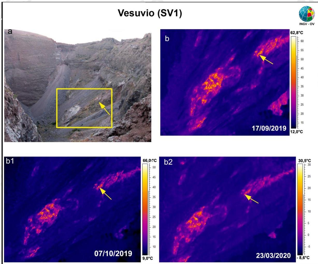
**Figura 3.3.2** – Settore meridionale del cratere del Vesuvio. Immagini nel visibile (a) e immagini termiche, relative all'area ricadente nel riquadro giallo (a), riprese il 17/09/2019 (b), il 07/10/2019 (b<sub>1</sub>) e il 23/03/2020 (b<sub>2</sub>) dal punto stazione SV1 di figura 1.1; la freccia gialla indica l'area che costantemente è a più alta temperatura.
