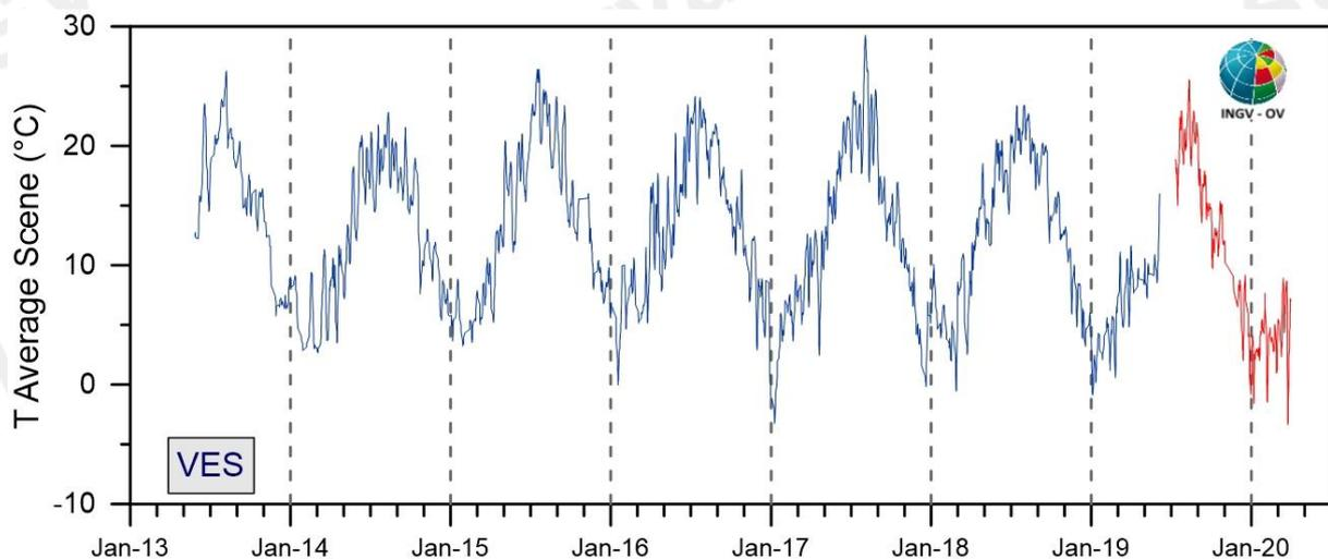
**Figura 3.1.3** - Stazione Vesuvio: Serie temporale dei valori medi di temperatura relativi ad ogni immagine acquisita con la precedente stazione (linea nera) e con quella di recente installazione (linea rossa).
