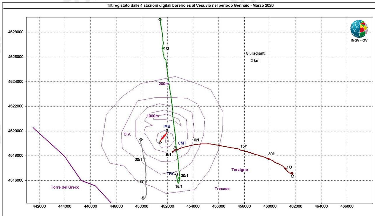
**Figura 2.2.2** – Pattern tiltmetrico osservato al Vesuvio. Per comodità di rappresentazione grafica e per una interpretazione più agevole, sono state selezionate in tale figura solo le 4 stazioni “borehole” con sensori ubicati a 25 m di profondità. Il lato di ogni maglia del reticolo equivale a 5  $\mu$ radianti o 2 km ed i pallini in colore sovrapposti sui vettori tilt indicano intervalli di 30 giorni.
