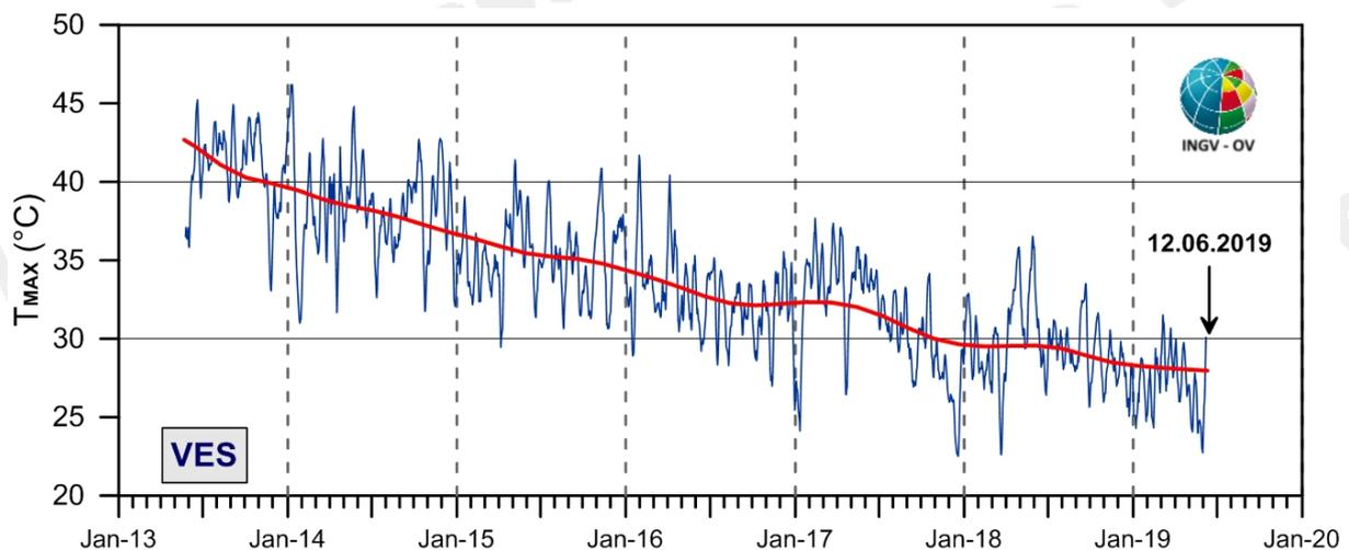
**Figura 3.1.2** - Stazione Vesuvio VES1. Serie temporali delle medie settimanali (blu) e del trend a lungo termine (rosso) dei valori di temperatura massima rilevati nell'immagine IR destagionalizzata mediante applicazione dell'algoritmo di filtraggio analitico STL.
