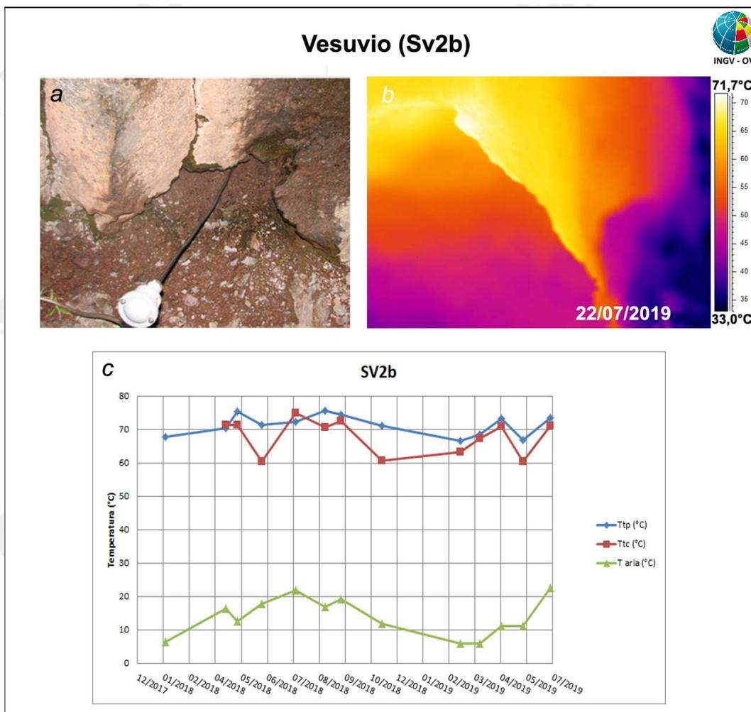
**Figura 3.2.2** – Immagini nel visibile (a) e termica (b) riprese al punto SV2b di figura 3.2.1, di una fumarola ubicata sul settore occidentale del cratere del Vesuvio. Valori massimi di temperatura con termocamera (Ttc) e valori di temperatura dalla termocoppia (Ttp), confrontati con la temperatura dell'aria misurata nel momento del rilievo termico, da gennaio 2018 a luglio 2019 (c).
