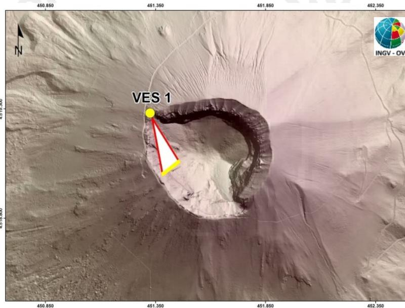
**Figura 3.1.1** - Mappa della Rete Permanente di Monitoraggio Termico ad immagine (TIRNet) operante al Vesuvio. Punto giallo: posizione della stazione; base del triangolo: area campionata.
