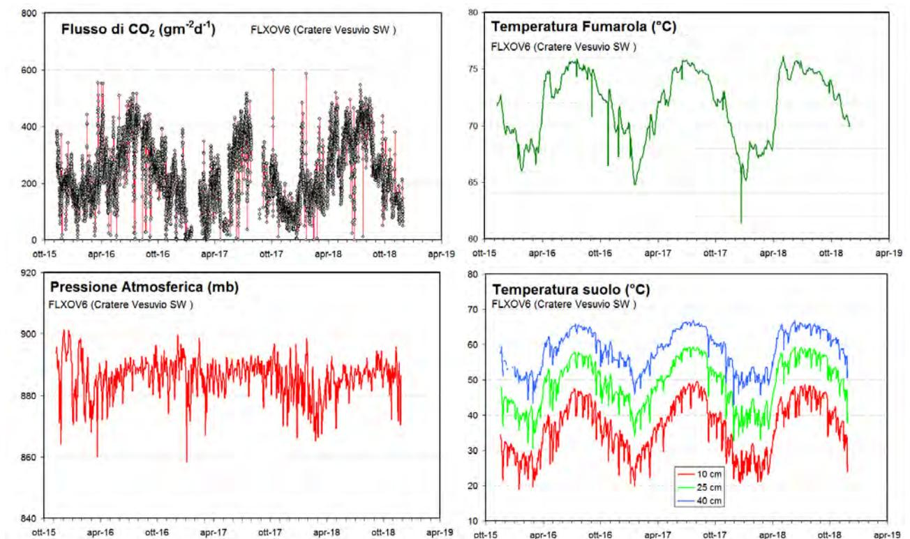
**Figura 4.2** - Parametri misurati dalla stazione geochimica (FLXOV6) installata in area bordo cratere del Vesuvio (settore SW). I valori, eccetto il flusso di CO<sub>2</sub> dal suolo, sono riportati come medie giornaliere.
