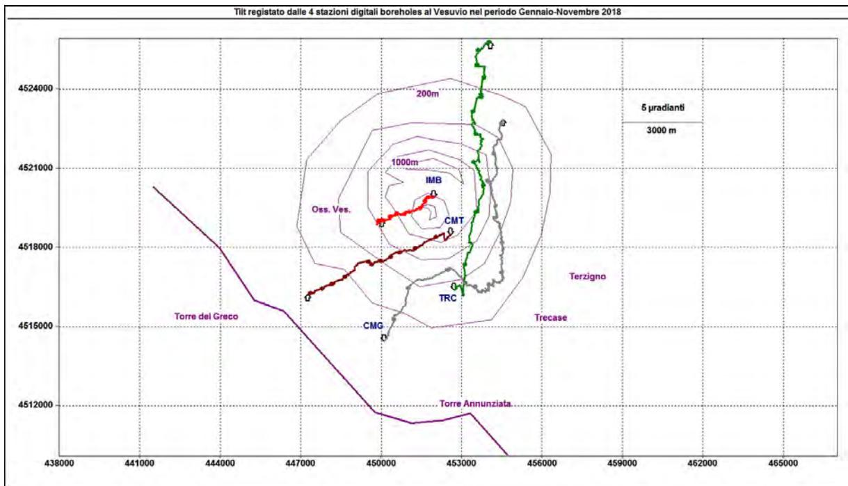
**Figura 2.7** – Odografo del tilting registrato alle stazioni del Vesuvio nel periodo gennaio-novembre 2018. Per chiarezza di rappresentazione grafica sono state selezionate solo le stazioni borehole con sensori ubicati tra 20 e 25 m di profondità. Il lato di ogni maglia del reticolo equivale ad 5 μradianti o 3.0 km. I pallini sovrapposti sui vettori tilt indicano l'inizio di ogni mese.
