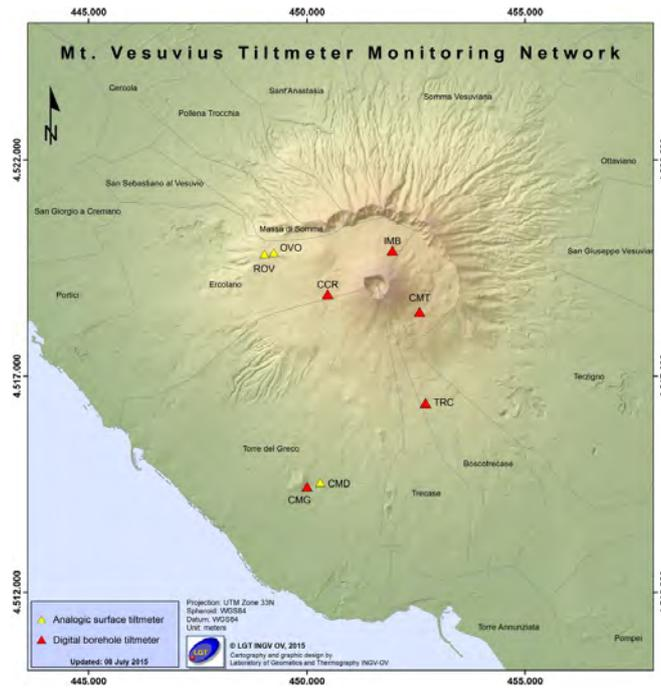
**Figura 2.6** – Rete Tiltmetrica del Vesuvio. La stazione CCR è in corso di completamento.
