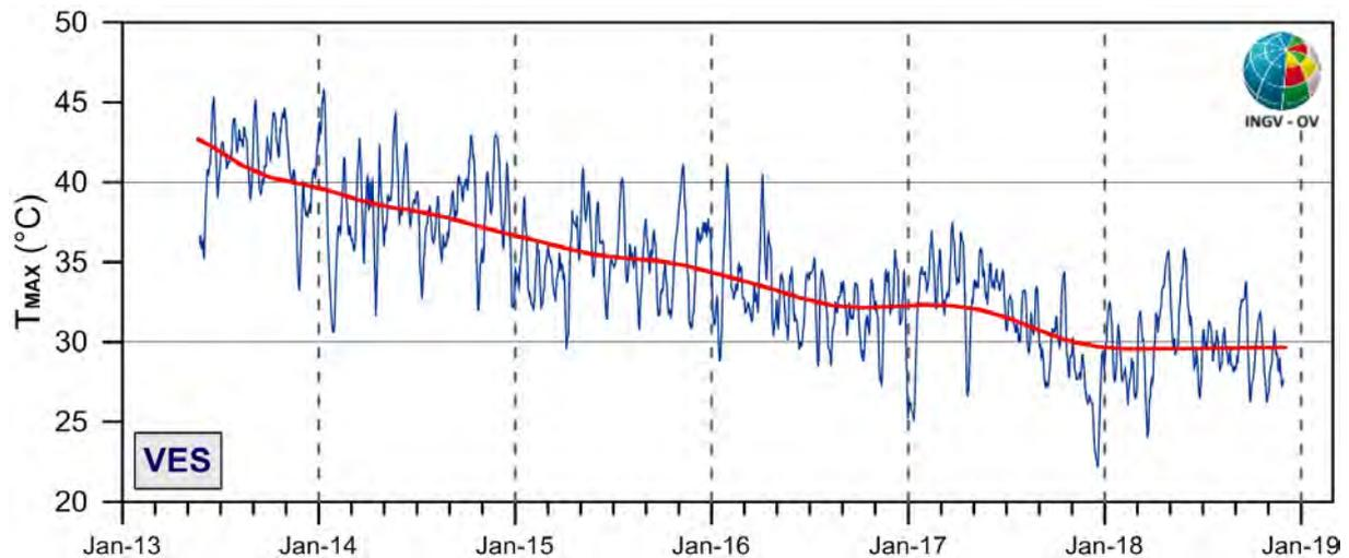
**Figura 3.2** - Stazione Vesuvio VES1. Serie temporali delle medie settimanali (blu) e del trend a lungo termine (rosso) dei valori di temperatura massima rilevati nell'immagine IR destagionalizzata mediante applicazione dell'algoritmo di filtraggio analitico STL.
