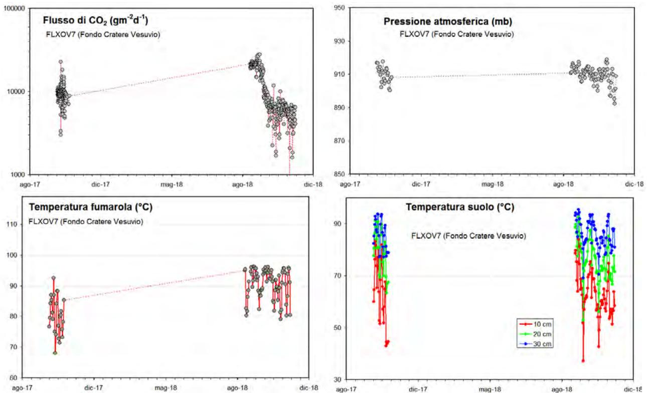
**Figura 4.3** - Parametri misurati dalla stazione geochimica (FLXOV7) installata in area di fondo cratero del Vesuvio. I valori, eccetto il flusso di CO<sub>2</sub> dal suolo, sono riportati come medie giornaliere.
