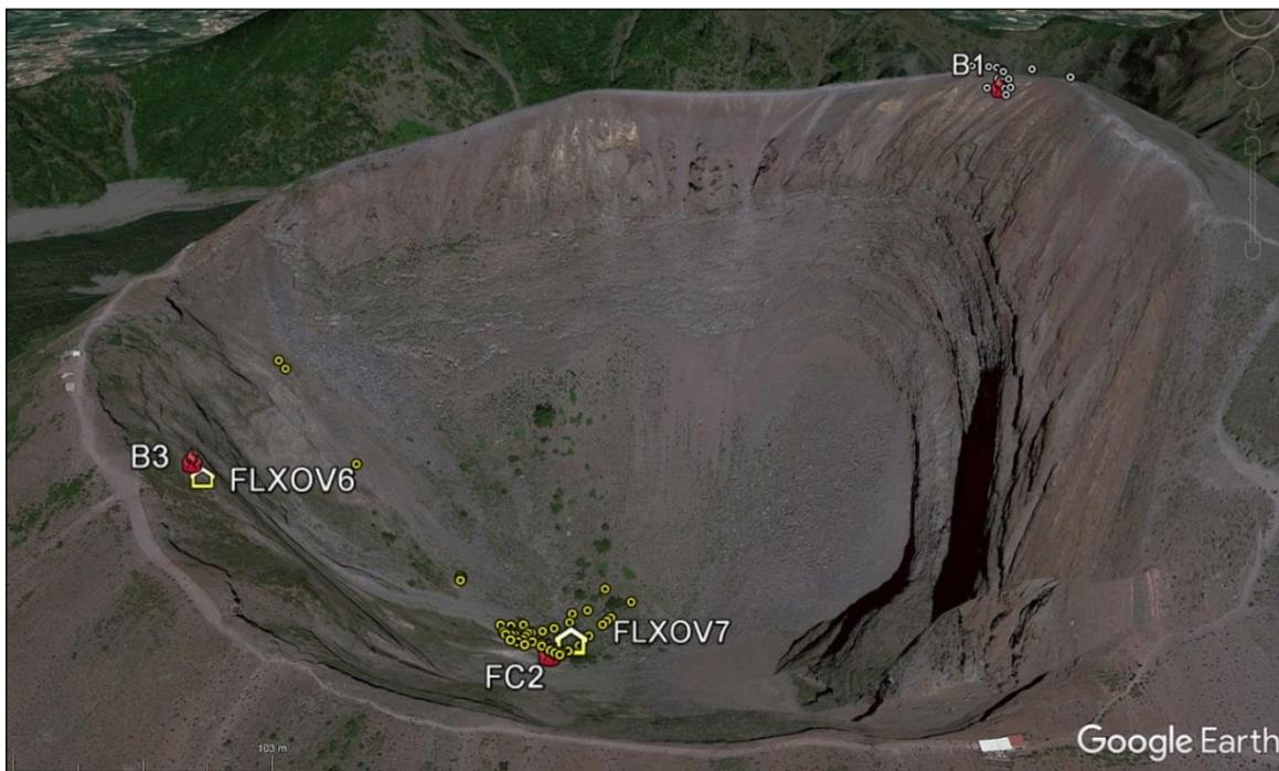
**Figura 4.1** - Ubicazione delle stazioni multiparametriche FLXOV6 e FLXOV7, e dei siti oggetto delle attività di sorveglianza geochimica in area craterica. In particolare, sono riportate le principali fumarole di bordo cratere (B1-B3) e di fondo cratere (FC2), sono inoltre riportati i punti fissi per la misura del flusso di CO<sub>2</sub> dal suolo e della temperatura del suolo, in area bordo cratere (simboli bianchi) e in area di fondo cratere (simboli gialli).
