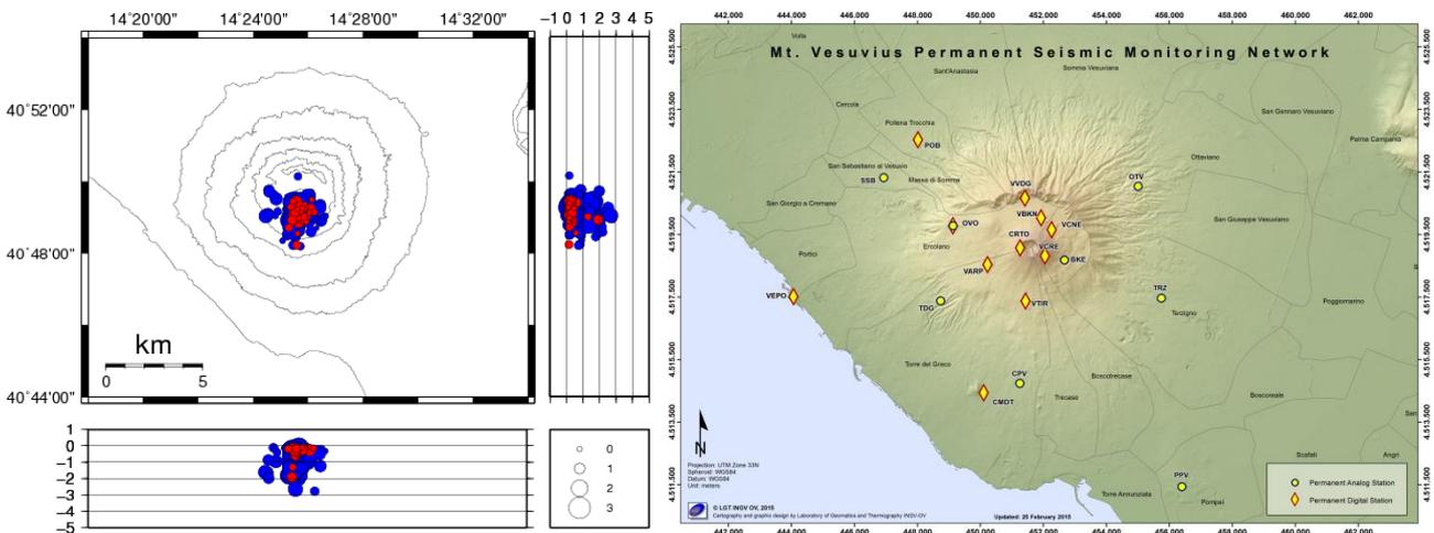
**Figura 1.2** - Localizzazioni ipocentrali al Vesuvio nel corso degli ultimi 12 mesi (in blu) e dell'ultimo mese (in rosso). La dimensione dei simboli è proporzionale alla magnitudo, come indicato nel riquadro in basso. A destra è mostrata la mappa della Rete Sismica Permanente del Vesuvio.
