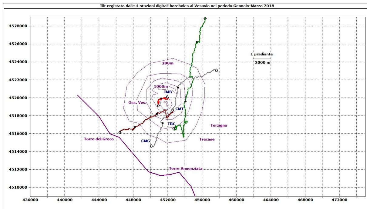
**Figura 2.6** – Odografo del tilting registrato alle stazioni del Vesuvio nel periodo gennaio-marzo 2018. Per chiarezza di rappresentazione grafica sono state selezionate solo le stazioni borehole con sensori ubicati tra 20 e 25 m di profondità. Il lato di ogni maglia del reticolo equivale ad 1  $\mu$ radiante o 2 km. I pallini neri sovrapposti sui vettori tilt indicano l’inizio di ogni mese.
