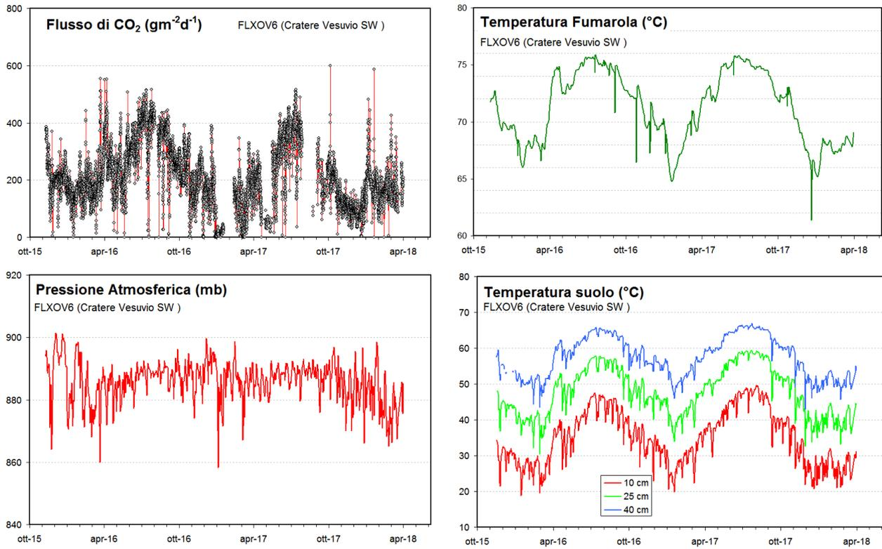
**Figura 4.2** - Parametri misurati dalla stazione geochimica (FLXOV6) installata in area bordo cratere del Vesuvio (settore SW). I valori, eccetto il flusso di CO<sub>2</sub> dal suolo, sono riportati come medie giornaliere.
