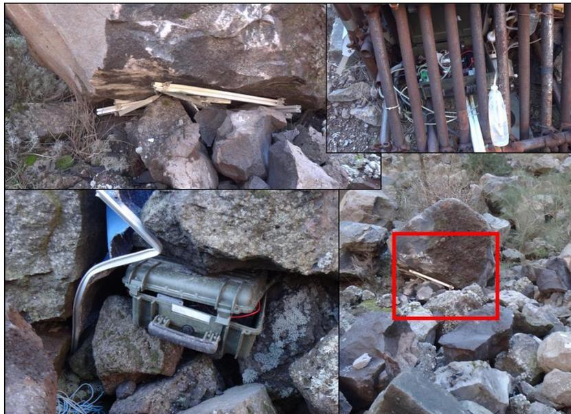
**Figura 4.3** - Eventi franosi hanno danneggiato il sistema di alimentazione combinato eolico-solare della stazione di fondo cratere FLXOV7.
