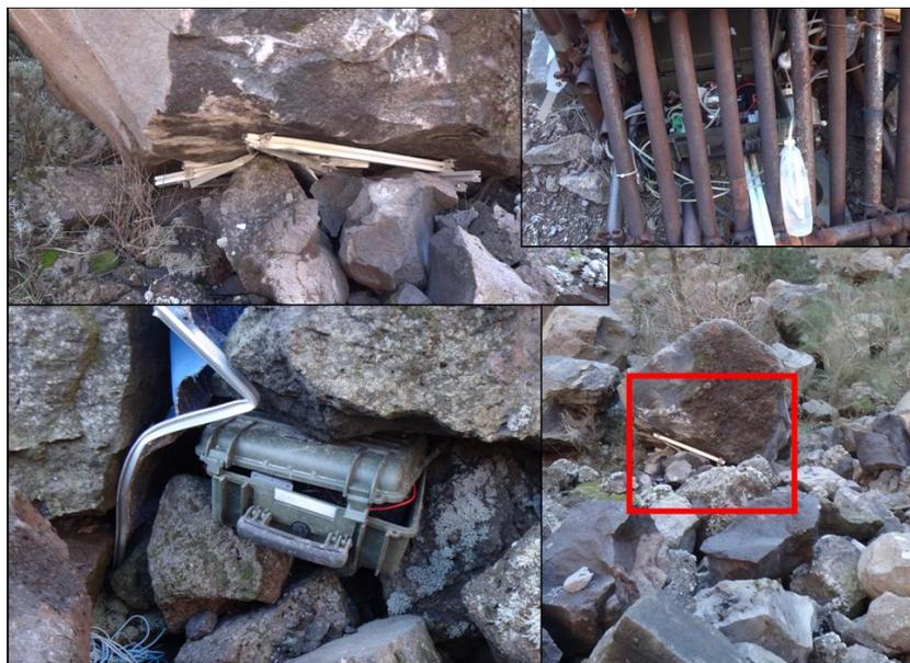
**Figura 4.7** - Eventi franosi hanno danneggiato il sistema di alimentazione combinato eolico-solare della stazione di fondo cratere FLXOV7.
